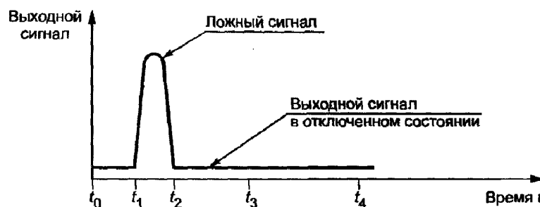
Рисунок 7б – Коммутационный элемент в выключенном состоянии
