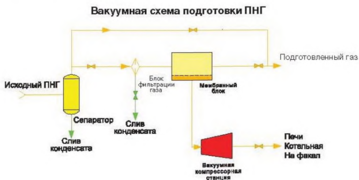
Рисунок 7.18 – Вакуумная схема мембранной подготовки ПНГ
