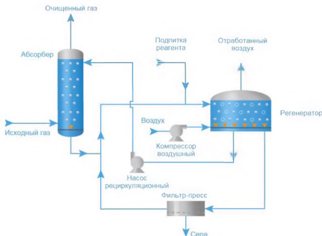
Рисунок 7.20 – Принципиальная схема установки жидкофазного окисления сероводорода хелатными комплексами железа
