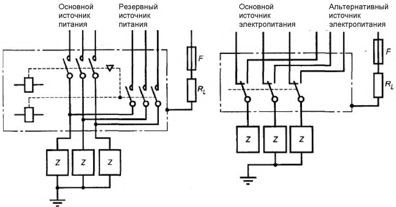
Примечание – На приведенной выше схеме соединений показаны электрические условия, однако механические условия на схеме отображать не обязательно.
