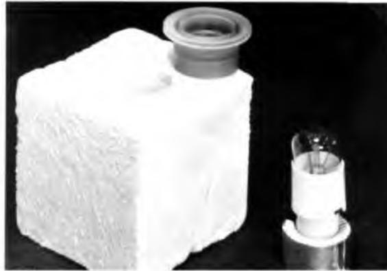
Рисунок ВВ.2 – Устройство испарения воды для наращивания инея
