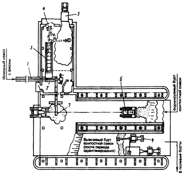
Рисунок 12 – Принципиальная схема технологии производства компстных смесей в процессе уборки навоза из помещений:
