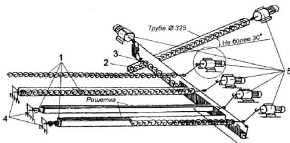
Рисунок 3 – Пространственная технологическая схема системы удаления навоза шнековыми транспортёрами:
