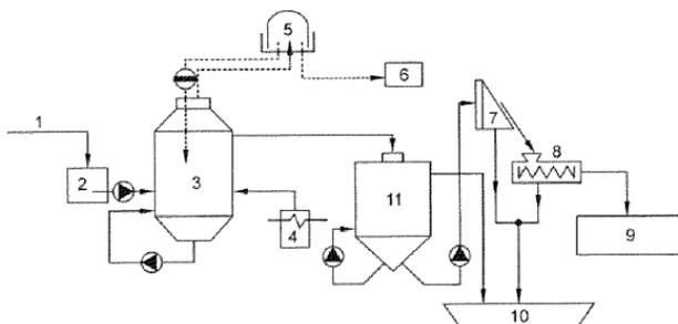
Рисунок 14 – Принципиальная технологическая схема системы анаэробного сбраживания свиного навоза:
