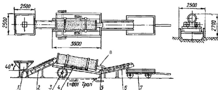
Рисунок 9 - Установка для промывки гравия из дренажных каналов отстойников:
