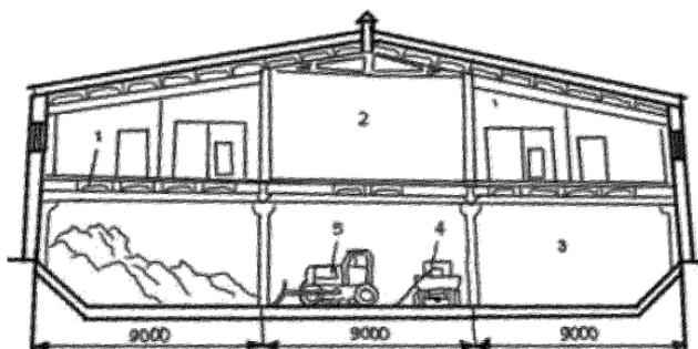
Рисунок 6 – Поперечный разрез коровника на 400 голов с подпольным навозохранилищем типа «моноподвал»:
