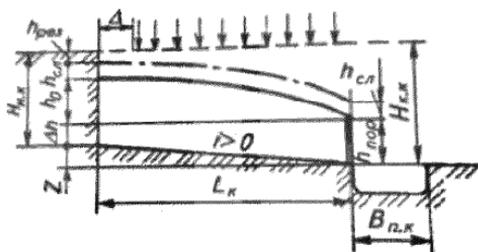
Рисунок 5 – Расчётная схема навозосборного канала
