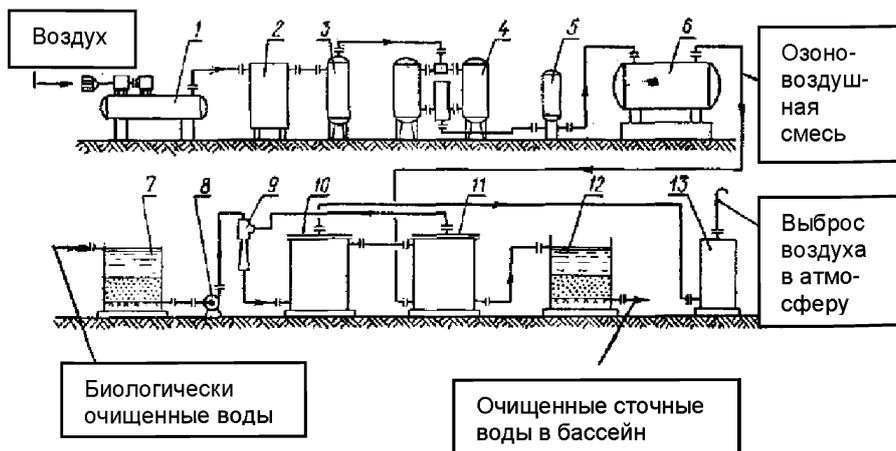
Рисунок 16 – Технологическая схема доочистки сточных вод озоном:
