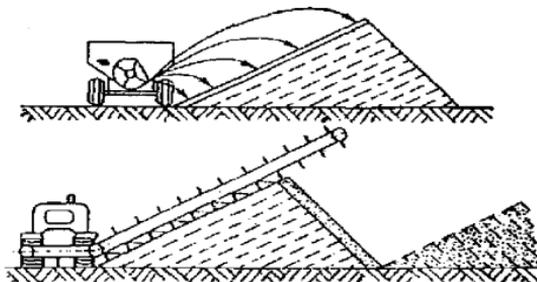
Рисунок 10 – Технологическая схема подготовки компоста с использованием окараваживающей машины ОФ-8
