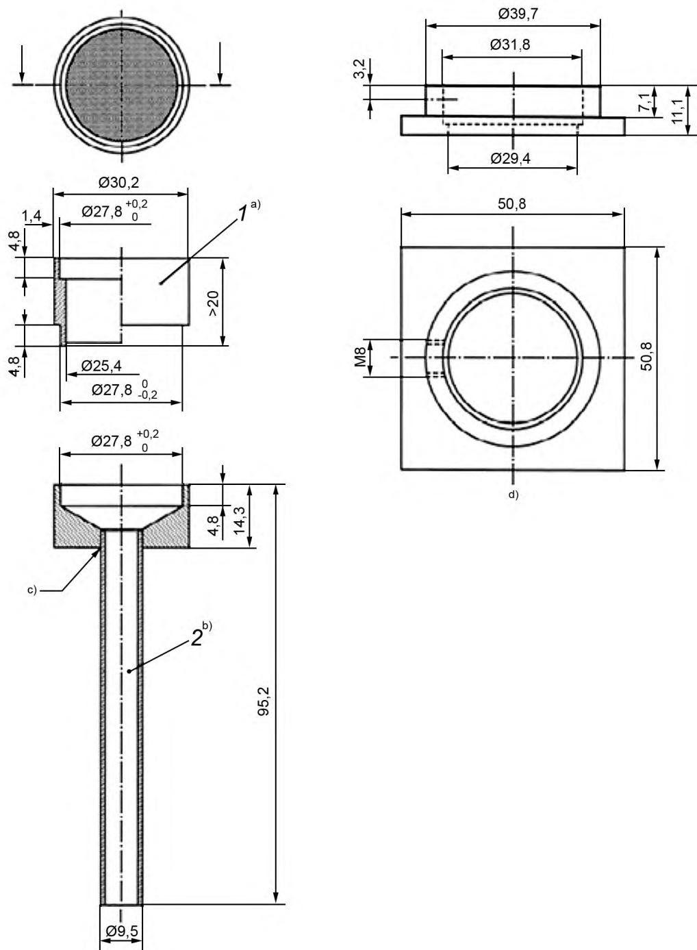
a) Внутренняя кромка верхней части и наружная кромка нижней части должны иметь углубление 1 мм для легкой укладки сит.
