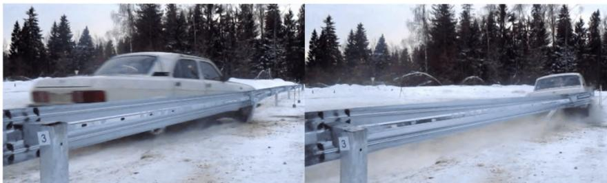
*Рисунок 3 – Работа барьерного дорожного ограждения с отделяющейся балкой устанавливаемой на обочине проезжей части при наезде ТС.*
