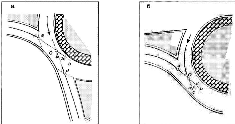
$O$  – вершина угла въезда на кольцевую проезжую часть; точка  $a$  – точка пересечения кромки кольцевой проезжей части с осью проезжей части въезда; точка  $d$  – точка пересечения кромки кольцевой проезжей части с осью проезжей части выезда; отрезок  $ab$  – направлен по касательной к оси проезжей части въезда; отрезок  $dO$  – направлен по касательной к оси проезжей части выезда; отрезок  $Oc$  – направлен по касательной к оси кольцевой проезжей части.
