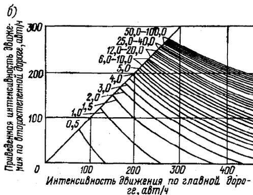
а - необорудованные пересечения, б – канализированные. Цифры на кривых – потери времени авт./ч.
