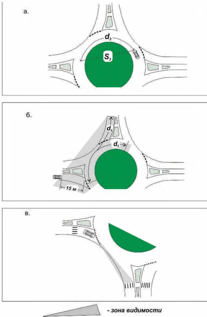
$d_3$  – остановочный путь при движении по кольцу;  $d_4$  – значение граничного расстояния между автомобилями движущимися по кольцевой проезжей части, используемое водителями при въезде на кольцо;  $d_5$  – граничное расстояние, используемое водителями при въезде на кольцо рассматриваемого направления.
