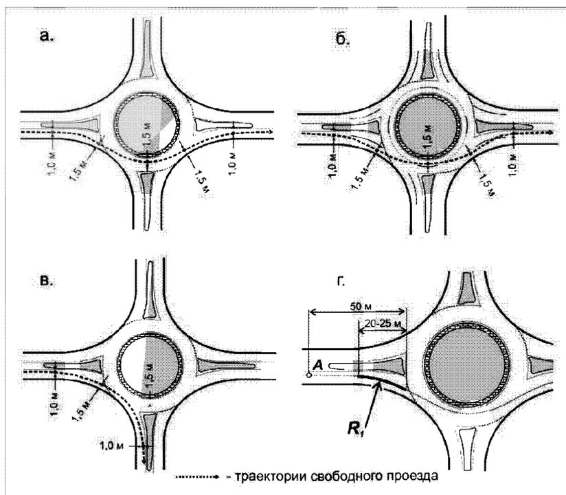
а – проезд однополосного кольцевого пересечения в прямом направлении, б - проезд двухполосного кольцевого пересечения в прямом направлении, в - правоповоротное движение, г - определение минимального радиуса ( $R_1$ ) свободного проезда на участке въезда
