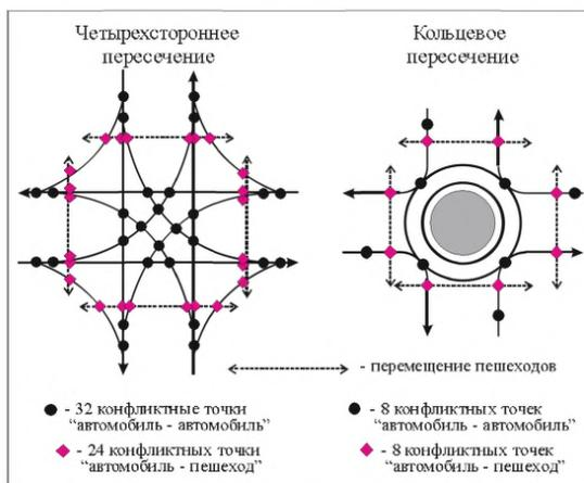
**Рисунок 4.1 - Конфликтные точки простого необорудованного и кольцевого пересечений**
