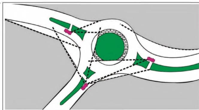
**Рисунок 9.5 - Пример объединенной схемы видимости**
