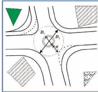
$D_1$  – диаметр центрально островка, около 5,0 м;  $D_2$  - диаметр окружности очерченной внешней кромке кольцевой проезжей части;  $b$  - ширина кольцевой проезжей части 4,2 м; пунктиром показано очертание кромки покрытия до реконструкции (четырёхсторонний нерегулируемый перекресток)
