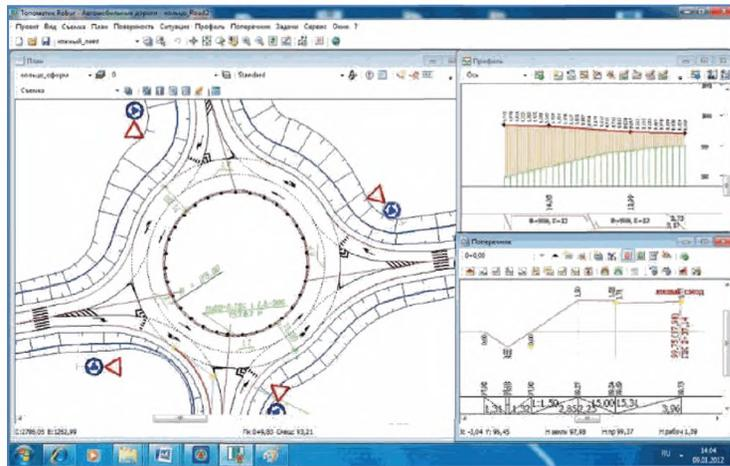
**Рисунок А.11 – Интерфейс программного комплекса «Топоматик Robur»**
