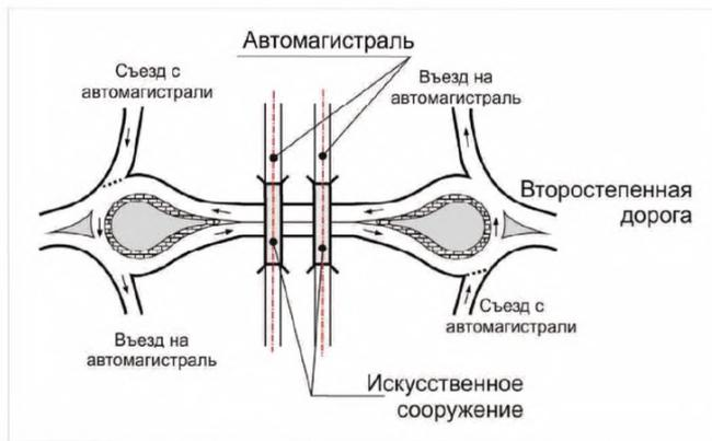
**Рисунок 7.4 - Схема расположения каплеобразных островков кольцевых пересечений на второстепенном направлении транспортной развязки ромб**
