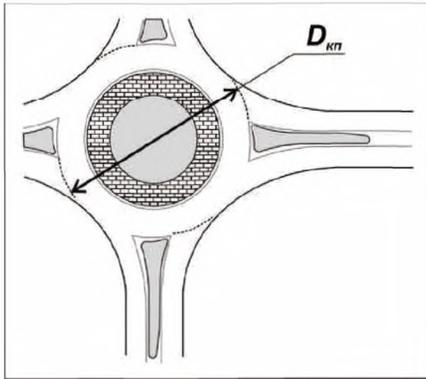
б - кольцевые пересечения со средним диаметром ( $D_{кп} = 30 - 50$  м)
