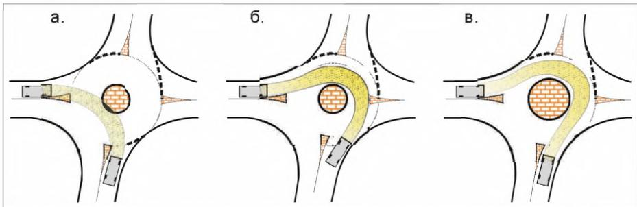
*а* - взаимное расположение островков не препятствующее возможному выезду автомобилей на кольцевую проезжую часть во встречном направлении; *б* – перекрытие возможного выезда во встречном направлении смещением направляющего островка к центру пересечения; *в* - перекрытие возможного выезда во встречном направлении за счет увеличения размеров центрального островка.
