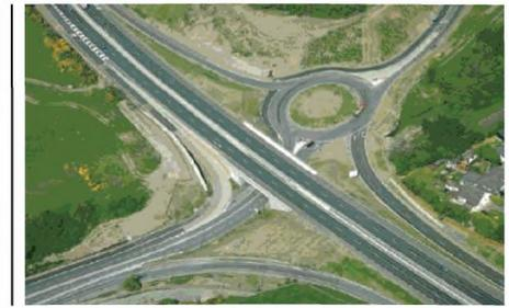
*Рисунок В.2 - Кольцевая организация движения под эстакадой на второстепенном направлении [7]*
