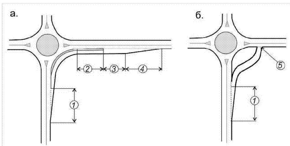
1 – участок отгона ширины полосы торможения; 2 – участок разгона переходно-скоростной полосы; 3 – участок маневрирования; 4 – участок отгона ширины переходно-скоростной полосы разгона; 5 – въезд на проезжую часть без полосы ускорения.
