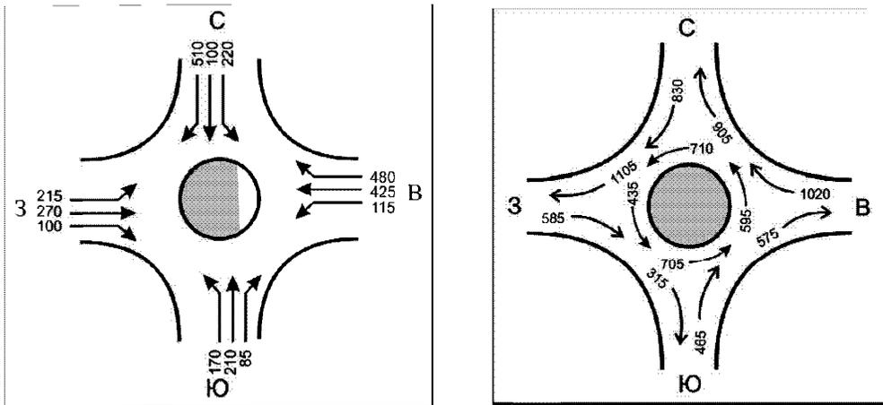
**Рисунок 5.1 - Графическое оформление картограммы движения на кольцевом пересечении**
