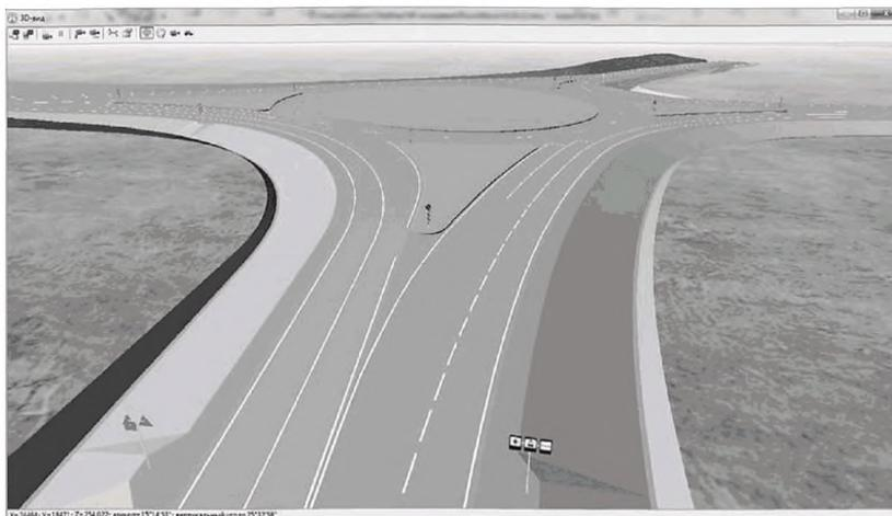
Рисунок А.9 – 3D-вид кольцевого пересечения (цифровая модель)
