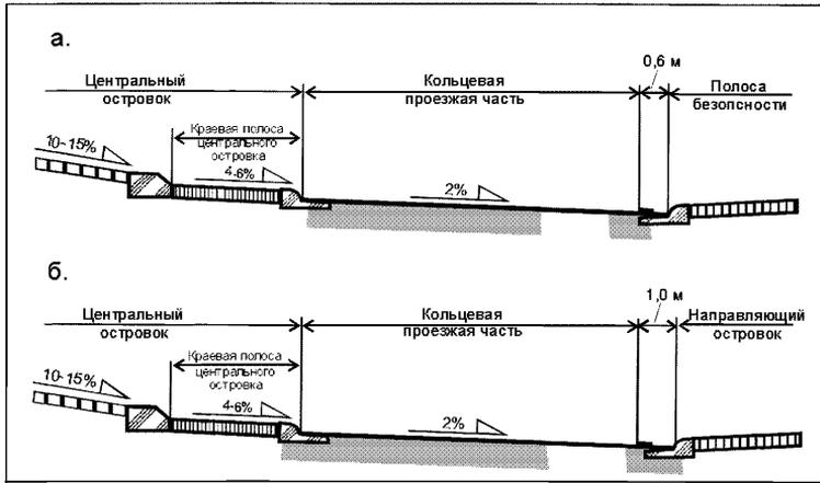
**Рисунок 5.7 - Сопряжение элементов поперечного профиля центральной зоны кольцевого пересечения на участке между примыкающими направлениями (а) и в сечении направляющего островка (б)**
