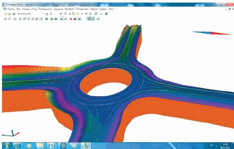
*Рисунок А.13 - Комплексная проектная поверхность кольцевого пересечения*
