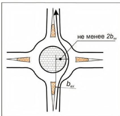
*Рисунок 6.7 - Смещение траектории движения при проезде мини-кольцевого пересечения*
