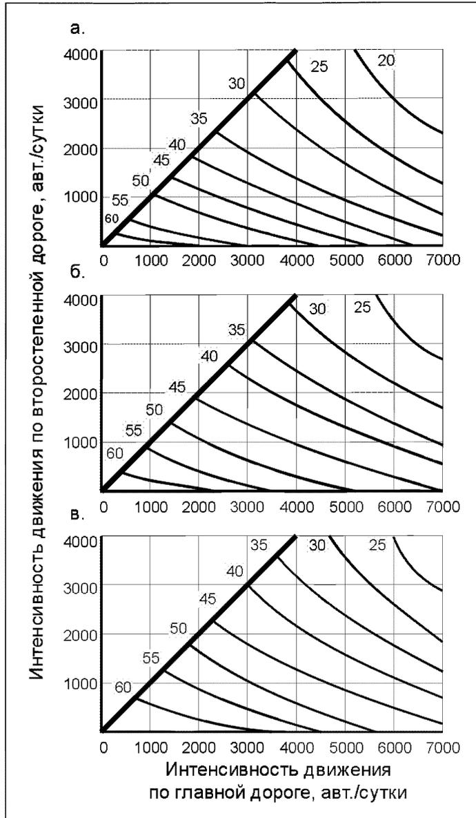
а – необорудованные пересечения; б – частично канализованные пересечения; в – полностью канализованные пересечения. Цифры на кривых – скорость движения, км/ч.
