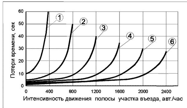
1 – пропускная способность полосы движения участка въезда 400 авт./час; 2 - то же, 800 авт./час; 3 - то же, 1200 авт./час; 4 - то же, 1600 авт./час; 5 - то же, 2000 авт./час; 6 - то же, 2400 авт./час;
