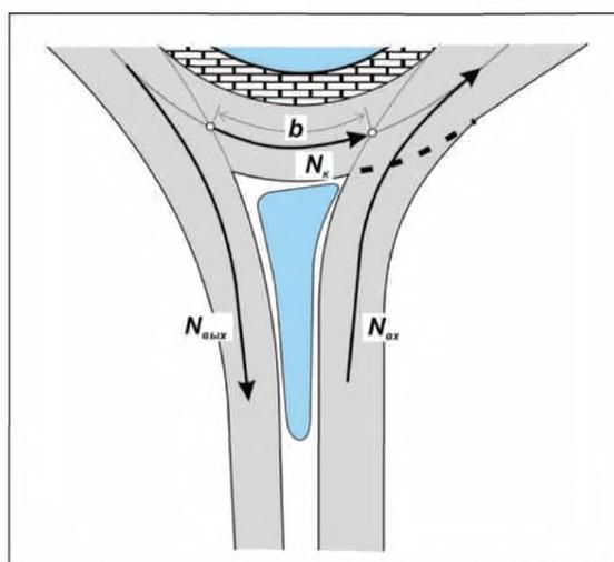
**Рисунок 14.7** - Схема к определению пропускной способности въезда
