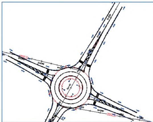
*Рисунок А.18 - Плановое решение кольцевого пересечения с добавленным примыкающим направлением*
