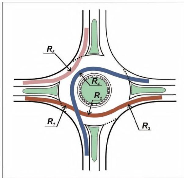
*Прямое направление:*  $R_1$  – минимальный радиус траектории въезда на кольцевую проезжую часть,  $R_2$  – минимальный радиус траектории движения по кольцевой проезжей части,  $R_3$  – минимальный радиус траектории движения при выезде с пересечения. *Левоповоротное движение:*  $R_4$  – минимальный радиус траектории при объезде центрального острьяка. *Правоповоротное движение:*  $R_5$  – минимальный радиус траектории при выполнении правого поворота.
