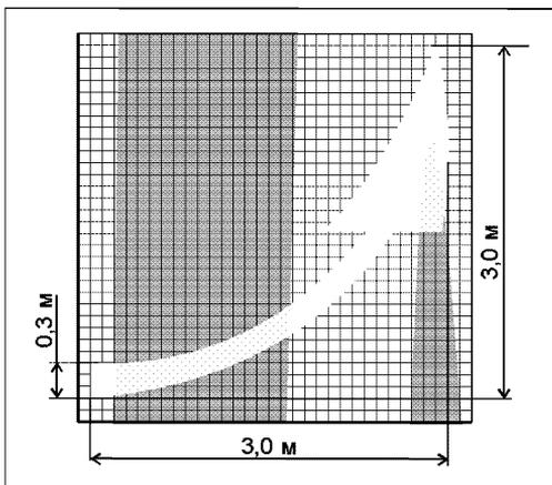
**Рисунок 12.5 – Размеры стрелы для указания направления движения на проезжей части мини-кольцевого пересечения**
