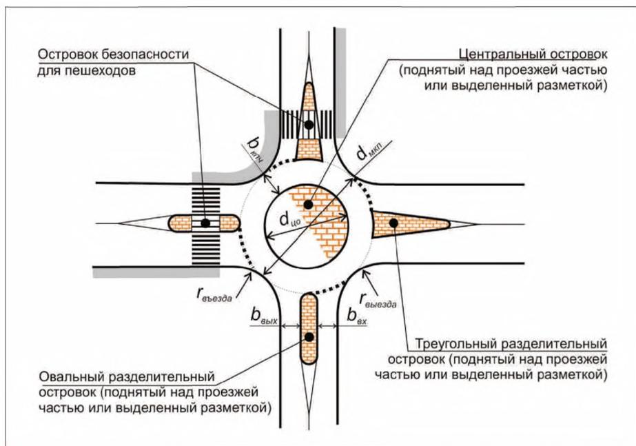
$d_{мкп}$  – диаметр мини-кольцевого пересечения;  $d_{цо}$  – диаметр центрального островка;  $b_{кнч}$  – ширина кольцевой проезжей части; ;  $b_{вх}$  и  $b_{вых}$  – ширины проезжей части при въезде и выезде ч кольца;  $r_{въезда}$  и  $r_{выезда}$  – радиусы кромок проезжей части (бортового камня) при въезде на кольцо и выезде с кольцевой проезжей части;
