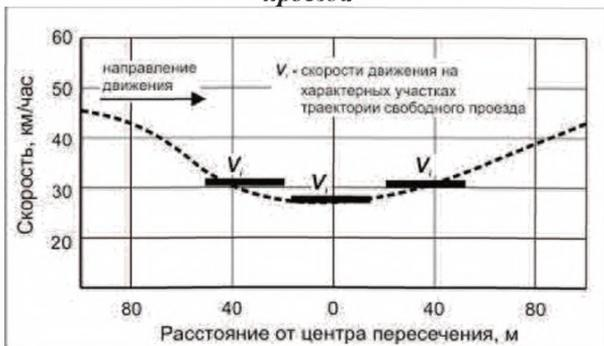
**Рисунок 14.5 – Этюра скорости проезда кольцевого пересечения**
