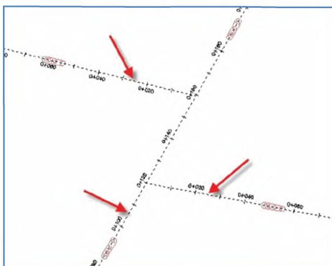
**Рисунок А.16 - Обозначение дорог, примыкающих к кольцевому пересечению**
