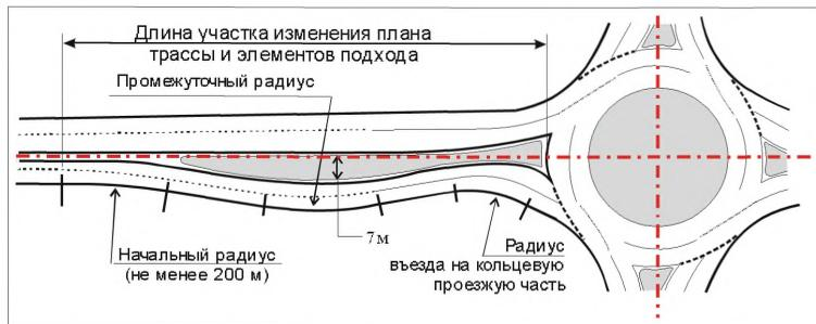
**Рисунок 5.12 - Уширение направляющего островка (центральной разделительной полосы)**
