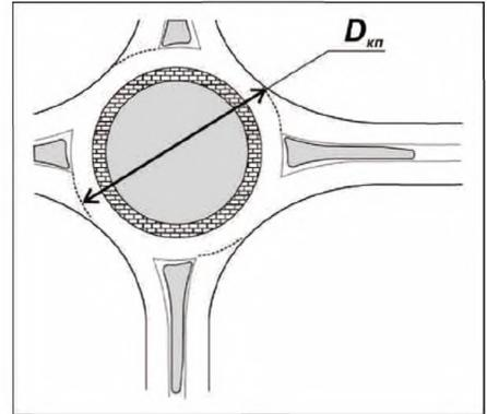
в - кольцевые пересечения большого диаметра ( $D_{кп} = 40 - 60$  м)
