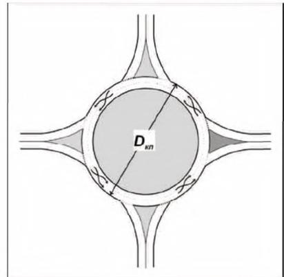
**Рисунок 4.4 - Схемы основных планировочных решений кольцевых пересечений**
