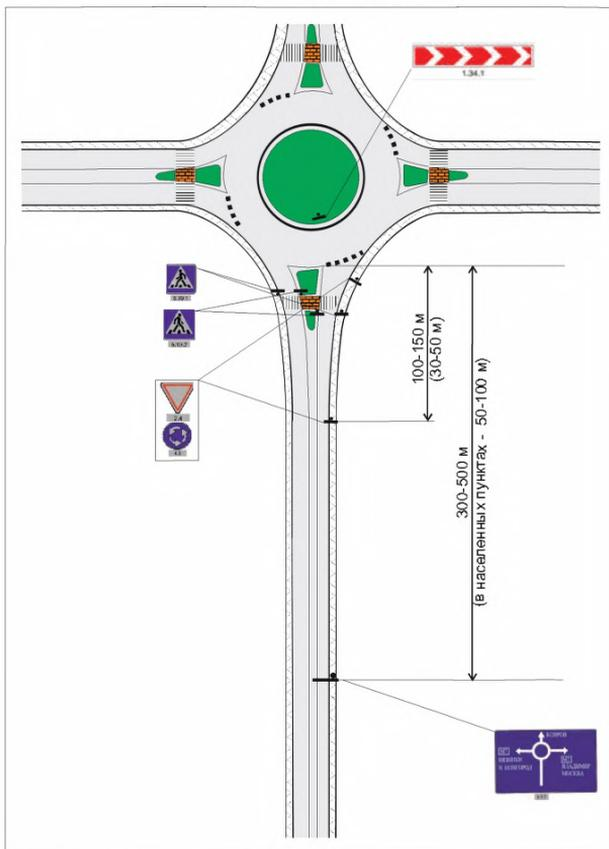
**Рисунок 12.9 - Схема установки дорожных знаков на кольцевом пересечении**
