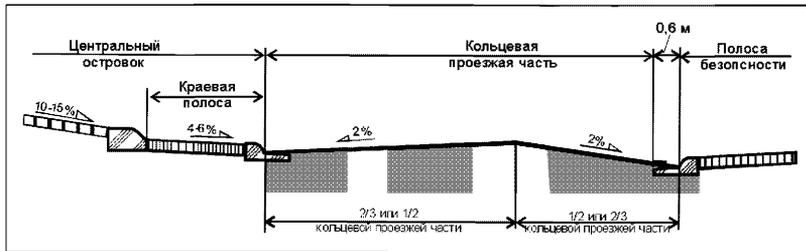
**Рисунок 8.2 - Двухскатный поперечный профиль многополосной кольцевой проезжей части**
