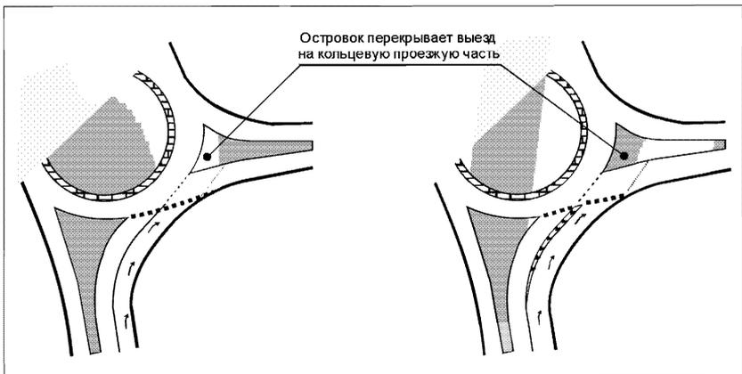
**Рисунок 5.26 - Перекрывание островком выхода правоповоротной полосы для исключения возможного выезда правоповоротного потока на кольцевую проезжую часть**
