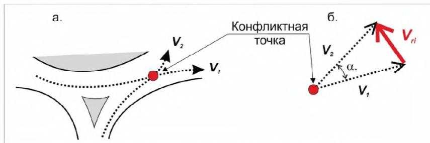
$V_1$  и  $V_2$  – скорости движения по траектории свободного проезда;  $V_{ri}$  – относительная скорость;  $\alpha$  – угол въезда на кольцо (см. п 14.1.1).
