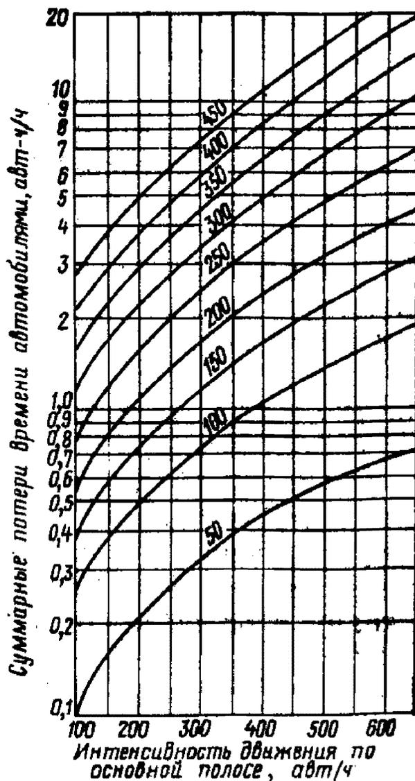
Цифры на кривых - интенсивность движения по съезду, авт./ч.
