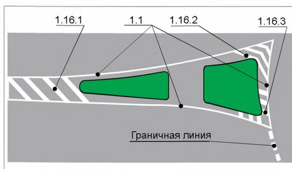
Рисунок 12.2 Пример нанесения разметки 1.16.1, 1.16.2 и 1.16.3 направляющего островка
