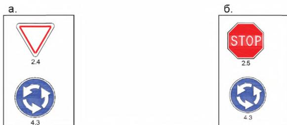
**Рисунок 12.8 - Сочетание дорожных знаков, установленных на участке въезда на кольцо, обеспечивающее приоритет движения транспортных средств, находящихся на кольцевой проезжей части**
