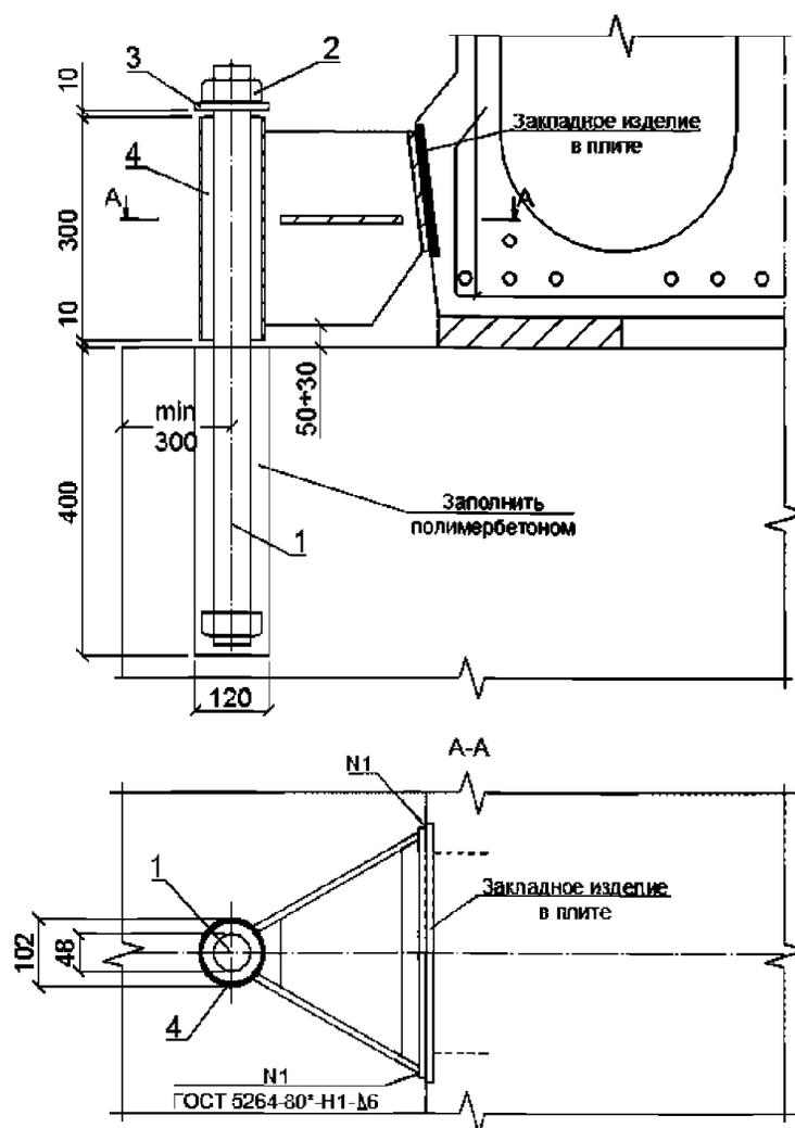
1 — анкерный болт; 2 — гайка; 3 — шайба; 4 — труба
