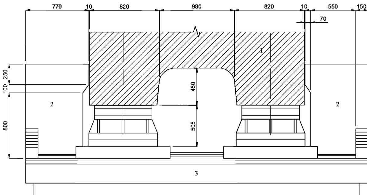
1 — пролетное строение; 2 — железобетонный стопор; 3 — устой
