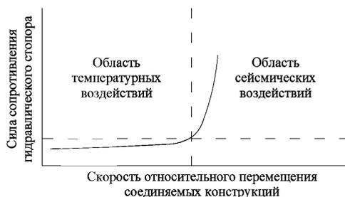
Рисунок А.9 — Схема работы гидравлического стопора
