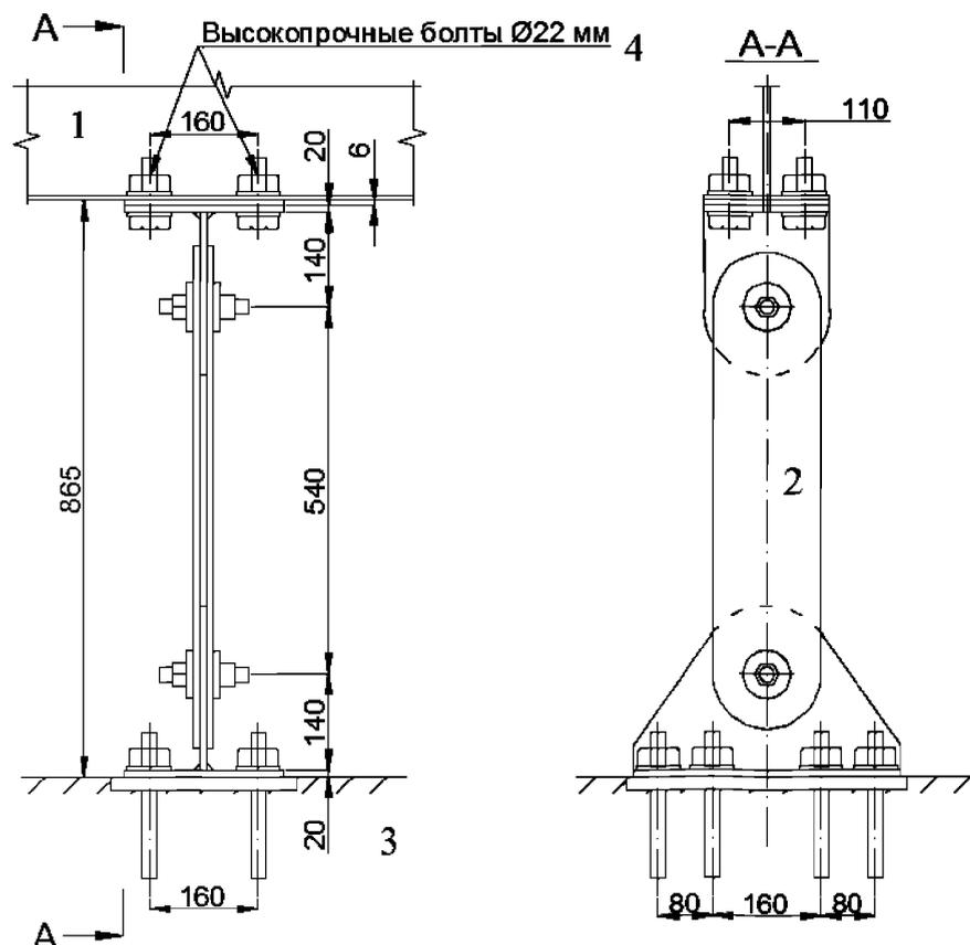
1 — домкратная балка пролетного строения; 2 — анкерное устройство; 3 — опора; 4 — высокопрочные болты
