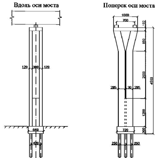
Рисунок А.13 — Промежуточная опора виадукта
