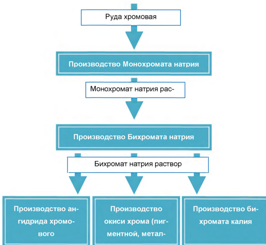
Рисунок 8.1 – Упрощенная схема связи производств основных соединений хрома между собой
