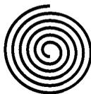
Рисунок 5 — Спиральная пружина
