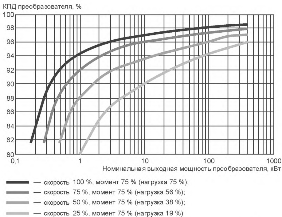
Рисунок 8 — Типичные характеристики энергоэффективности двухзвенных преобразователей трехфазного напряжения с пассивным препроцессором для типичных уровней нагрузки при постоянном крутящем моменте
