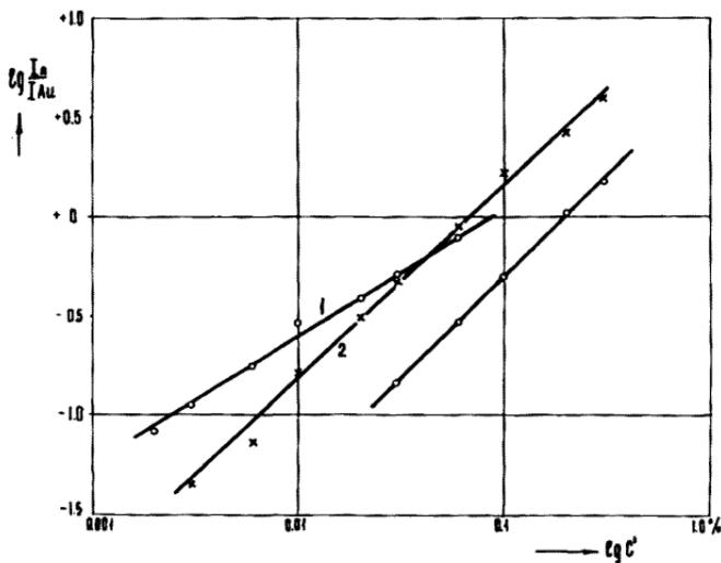
Рис.3. Градуировочные графики для определения теллура (2) и свинца по линии Рb I 288, 307 нм (1) и по линии Рb I 289, 379 нм (3).
