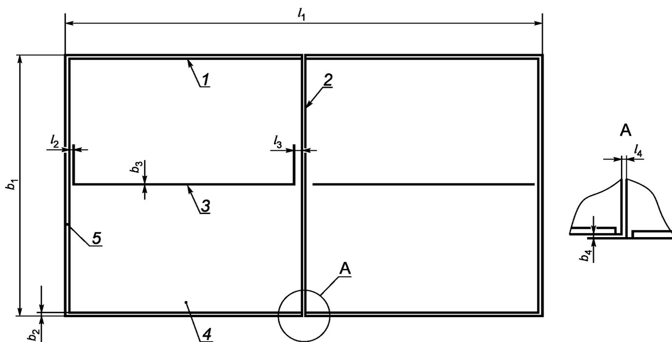
1 — боковая линия; 2 — зона для сетки; 3 — центральная линия; 4 — половина столешницы; 5 — базовая линия
