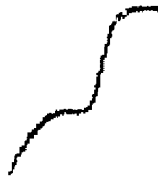
Рис. Полярографическая волна свинца в растворе цитрата аммония. Концентрация свинца 20 мкг/мл.
