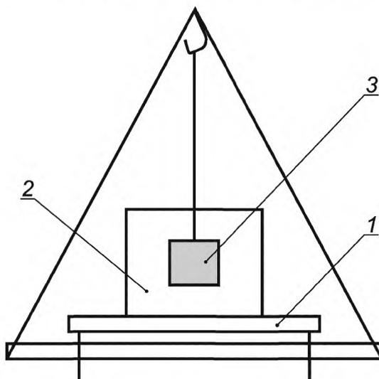
1 — подставка для стакана; 2 — стакан с рабочей жидкостью; 3 — образец наноматериала
