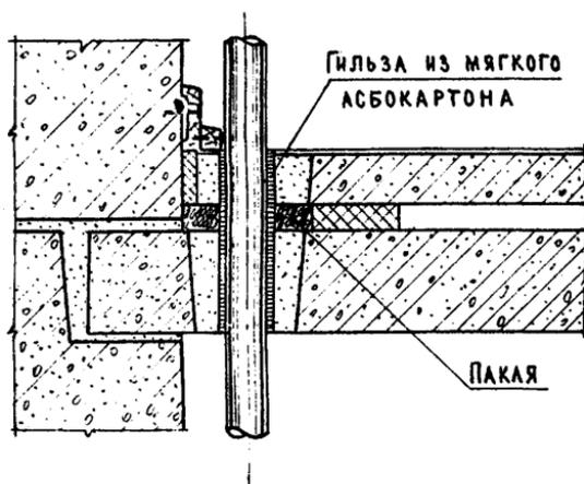
Рис. 9 Прогонка стояка отопления через перекрытие
