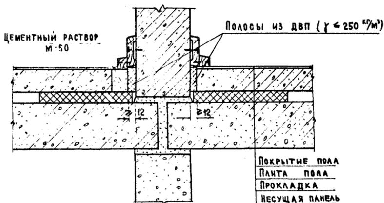
Рис. 8 Примыкание панели основания к стенам и перегородкам
