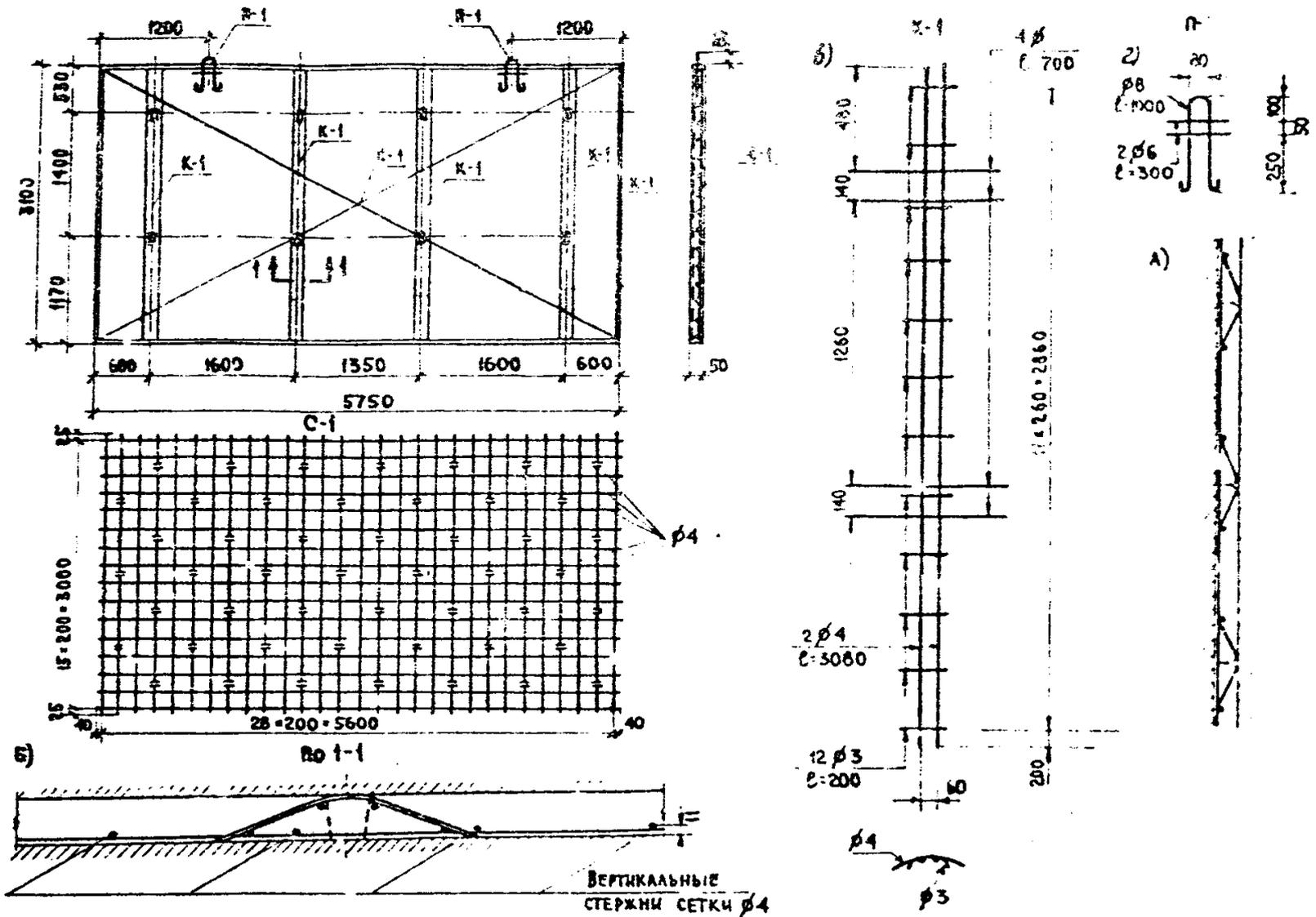
Рис. 6 Пример армирования панелей (в - вертикальный арматурный каркас, г - сетки вертикального подъема) и фиксации арматурной сетки, а - отгибом разрезанных стержней, б - гнутым каркасом, установленным по линии монтажных отверстий
