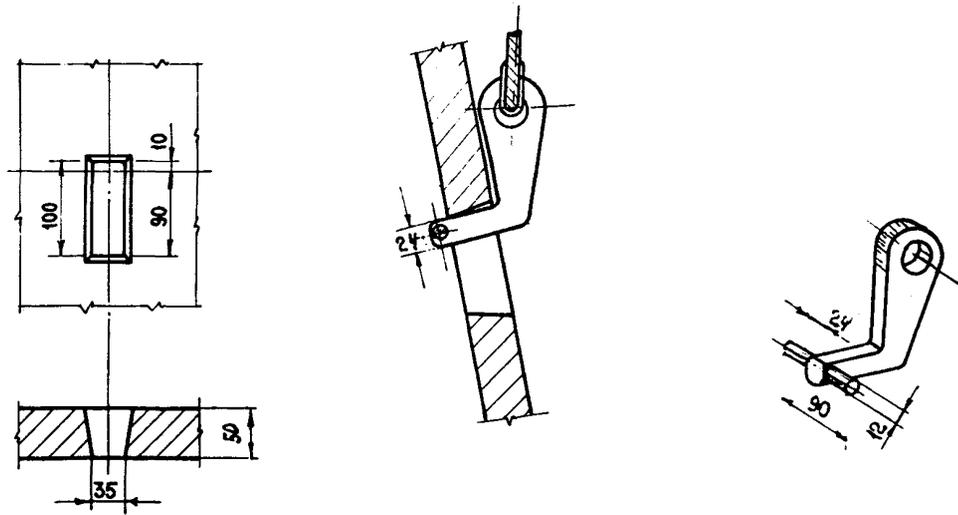
Рис. 4 Конструкция захвата и схема привязки монтажного отверстия
