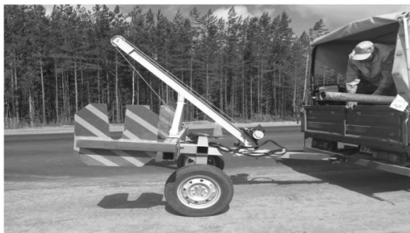
Рисунок 10.2 - Автомобиль с прицепом-разматывателем сетки
