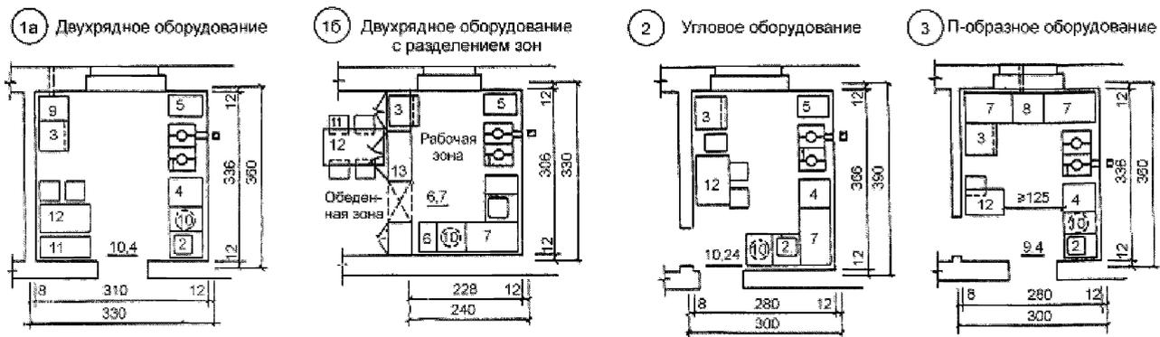
Рис. В.8. Кухни с плитой на твердом топливе для квартир на первых этажах в домах без водоснабжения и канализации:
