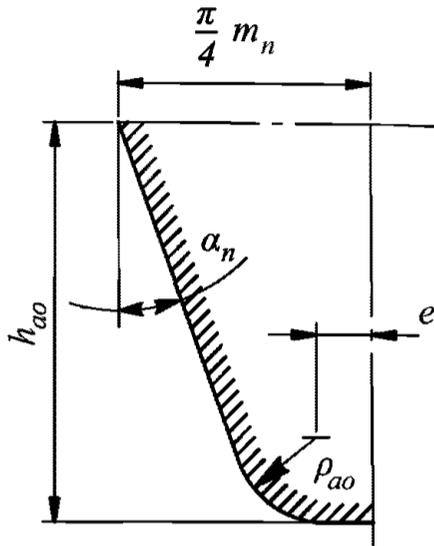
Рис. 4.2.2.7.3.2-2 Исходный производящий контур фрезы без протуберанца
