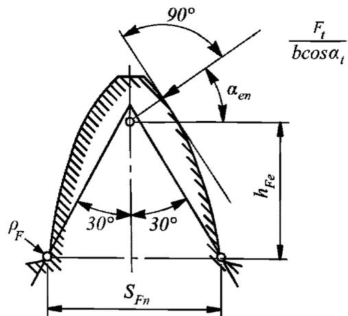
Рис. 4.2.2.7.3.2-1 К определению  $Y_F$  для случая внешнего зацепления
