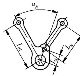
Рис. 2.4.3-2 Прицепной шатун
