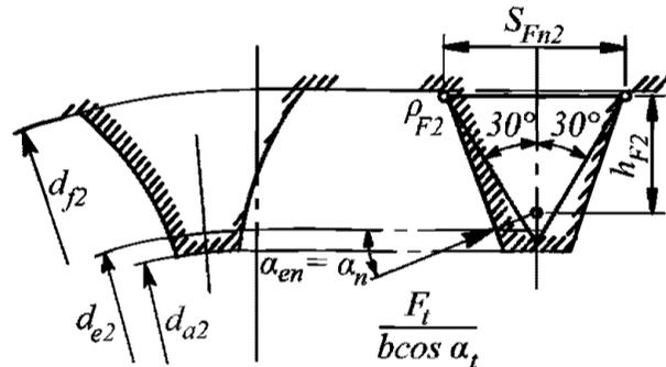
Рис. 4.2.2.7.3.2-4 К определению  $Y_F$  для случая внутреннего зацепления
