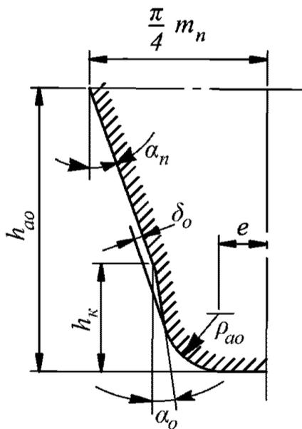
Рис. 4.2.2.7.3.2-3 Исходный производящий контур фрезы с протуберанцем
