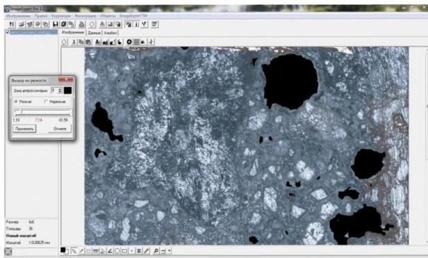
Рисунок 6 – Результат применения фильтра по резкости
