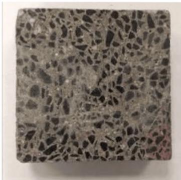
Рисунок 2 – Поверхность образца бетона после шлифовки-полировки
