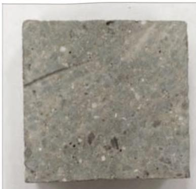
Рисунок 1 – Исходный образец бетона для проведения измерений
