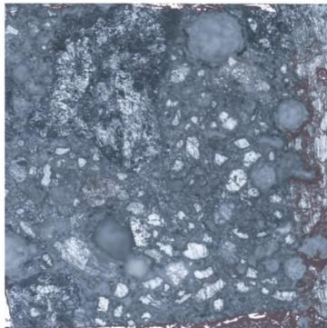
Рисунок 5 – Пример полученного панорамного изображения образца цементобетона
