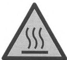
Рисунок 15 — Предупреждающий знак «Опасность от нагретой поверхности»
