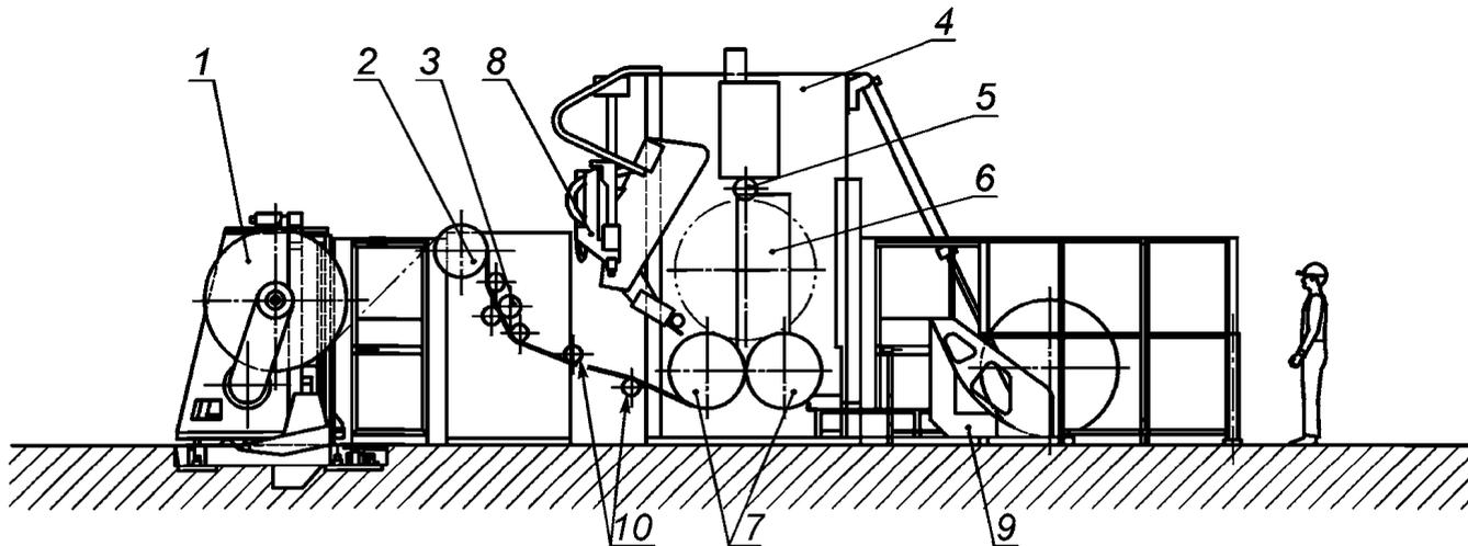
1 — машинный рулон в раскате; 2 — бумаговедущий вал; 3 — узел продольной резки полотна; 4 — станина наката; 5 — прижимной вал; 6 — бумажный рулон; 7 — несущие валы; 8 — сталкиватель бумажного рулона; 9 — устройство для опускания бумажного рулона; 10 — бумаговедущие валы
