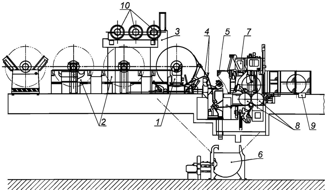
1 — машинный рулон в раскате; 2 — машинные рулоны; 3 — накопитель тамбурных валов; 4 — бумаговедущие валы; 5 — узел продольной резки полотна; 6 — гидроразбиватель брака; 7 — накат; 8 — несущие валы; 9 — упор; 10 — тамбурные вал
