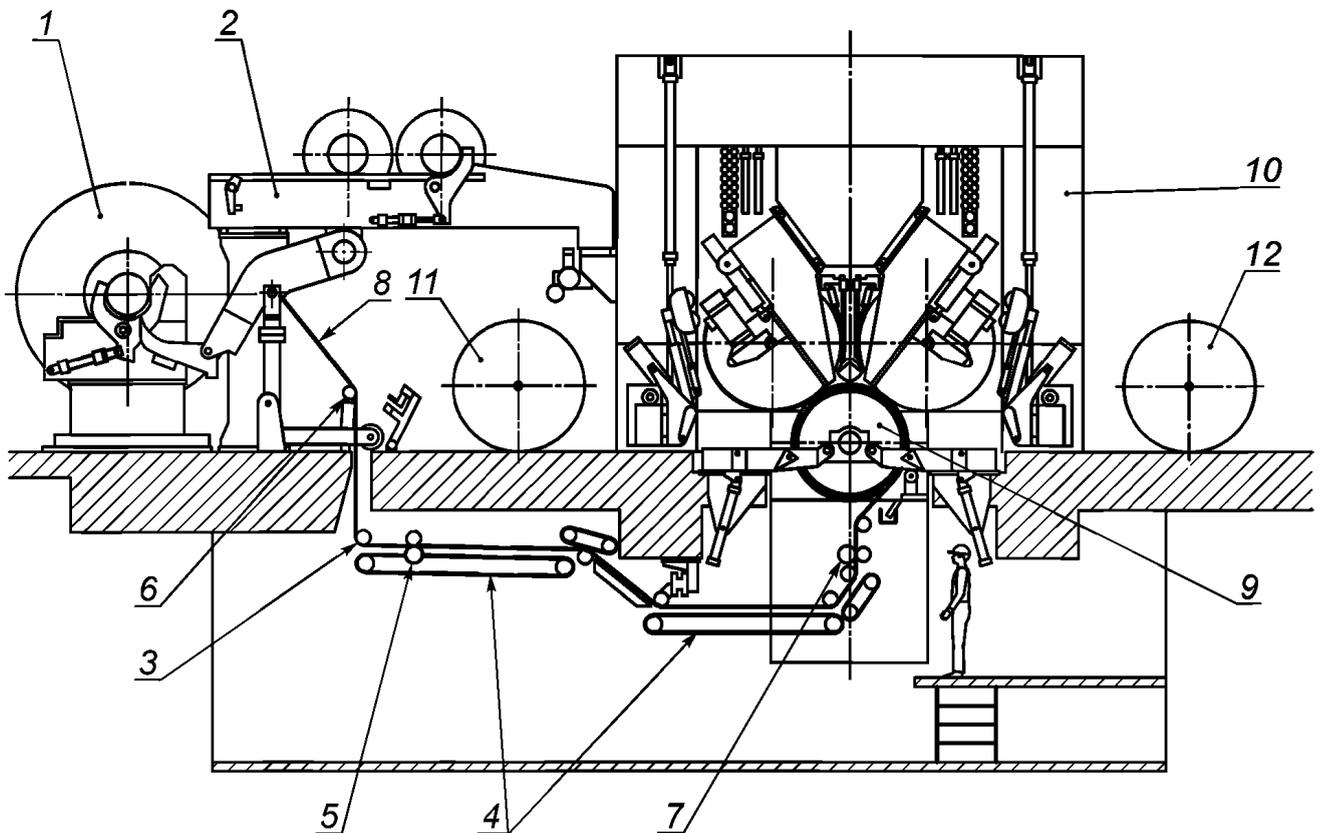
1 — машинный рулон в раскате; 2 — накопитель тамбурных валов; 3 — бумаговедущие валы; 4 — устройство для заправки полотна; 5 — устройство для обрезки кромок полотна; 6 — измерение натяжения полотна; 7 — узел продольной резки полотна; 8 — бумажное полотно; 9 — несущий вал; 10 — накат; 11 — выгруженный бумажный рулон; 12 — выгруженный бумажный рулон
