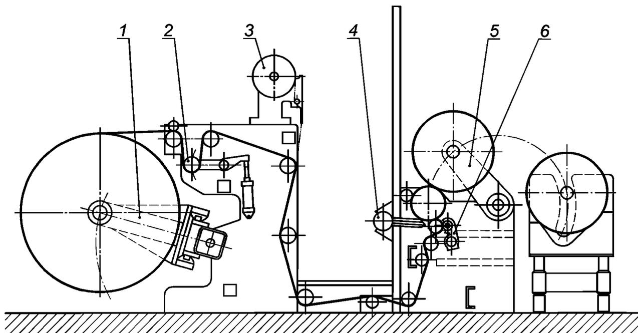
1 — машинный рулон в раскате; 2 — измерение натяжения бумажного полотна; 3 — устройство для упаковочной бумаги; 4 — устройство отсоса обрезков боковых кромок; 5 — бумажный рулон в накате; 6 — узел продольной резки полотна
