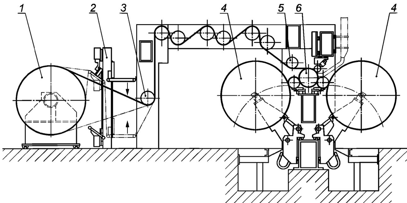
1 — машинный рулон в раскате; 2 — устройство поперечной резки и склейки бумажного полотна; 3 — измерение натяжения бумажного полотна; 4 — бумажные рулоны в накате; 5 — расправляющий вал; 6 — узел продольной резки полотна
