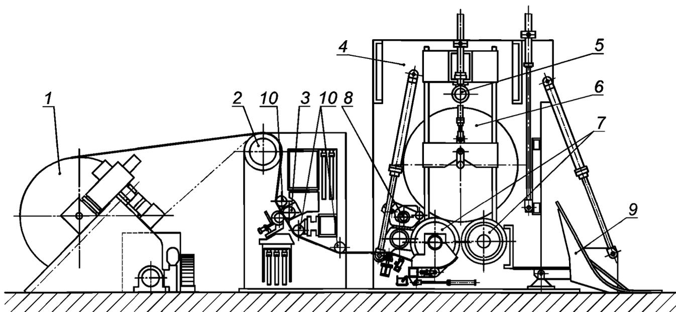
1 — машинный рулон в раскате; 2 — расправляющий вал; 3 — узел продольной резки полотна; 4 — накат; 5 — прижимной вал; 6 — бумажный рулон в накате; 7 — несущие валы; 8 — сталкиватель бумажного рулона; 9 — устройство для опускания бумажного рулона; 10 — бумаговедущие валы
