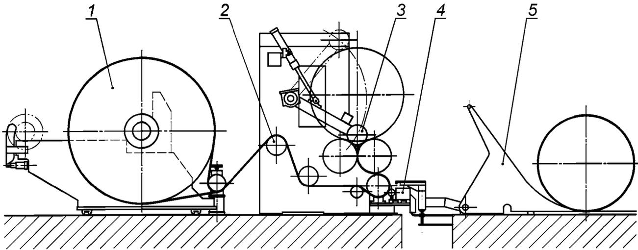
1 — машинный рулон в раскате; 2 — измерение натяжения бумажного полотна; 3 — бумажный рулон в накате; 4 — узел продольной резки полотна; 5 — устройство для выгрузки бумажного рулона
