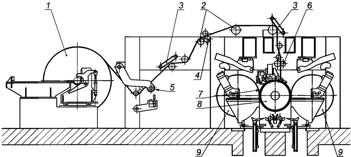
1 — машинный рулон в раскате; 2 — бумаговедущие валы; 3 — устройство для заправки бумажного полотна; 4 — устройство для обрезки боковых кромок; 5 — измерение натяжения бумажного полотна; 6 — узел продольной резки полотна; 7 — полоса разрезанного вдоль полотна; 8 — центральный несущий (опорный) вал; 9 — бумажный рулон в накате
