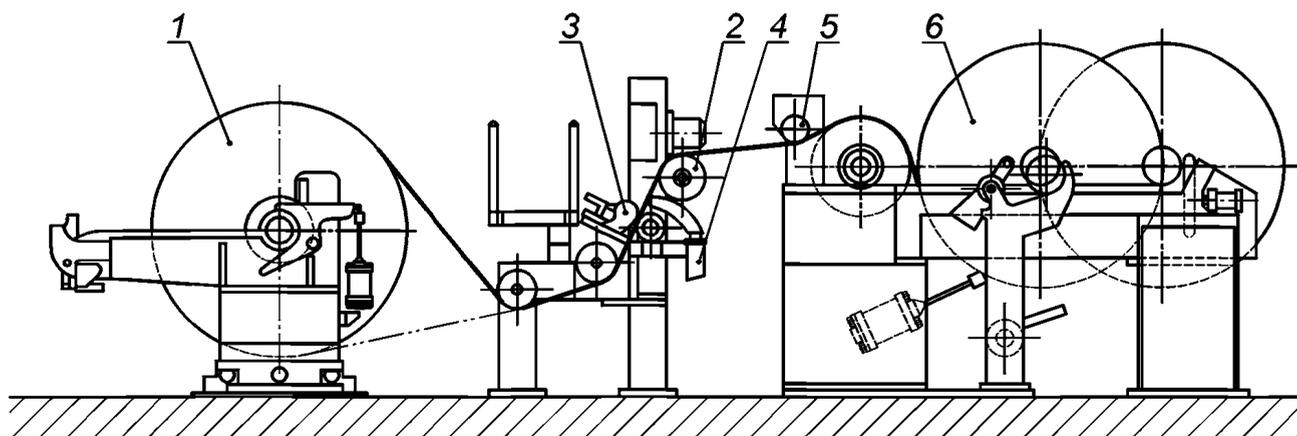
1 — машинный рулон в раскате; 2 — измерение натяжения бумажного полотна; 3 — узел продольной резки полотна; 4 — система всасывания обрезков боковых кромок; 5 — расправляющий вал; 6 — бумажный рулон в накате
