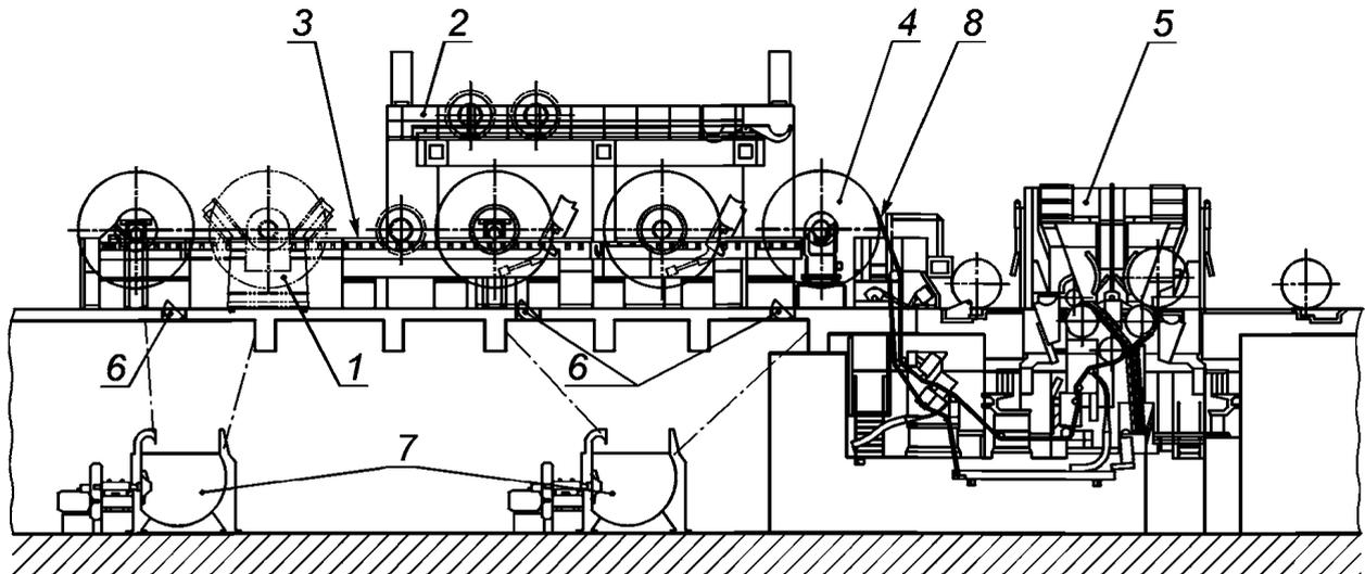
1 — тележка машинного рулона; 2 — накопитель тамбурных валов; 3 — накопитель машинных рулонов; 4 — машинный рулон в раскате; 5 — накат; 6 — крышки люка гидроразбивателя брака; 7 — гидроразбиватели брака; 8 — бумажное полотно
