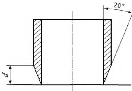
Рисунок 1 – Конструкция резака
