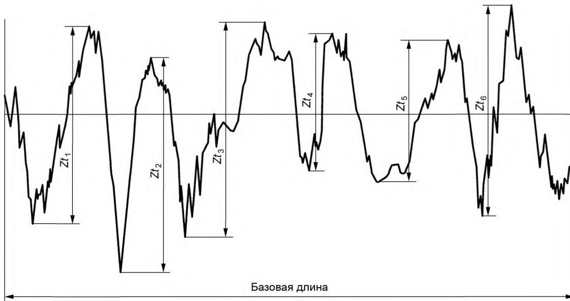
Рисунок 9 — Высота элементов профиля (пример профиля шероховатости)
