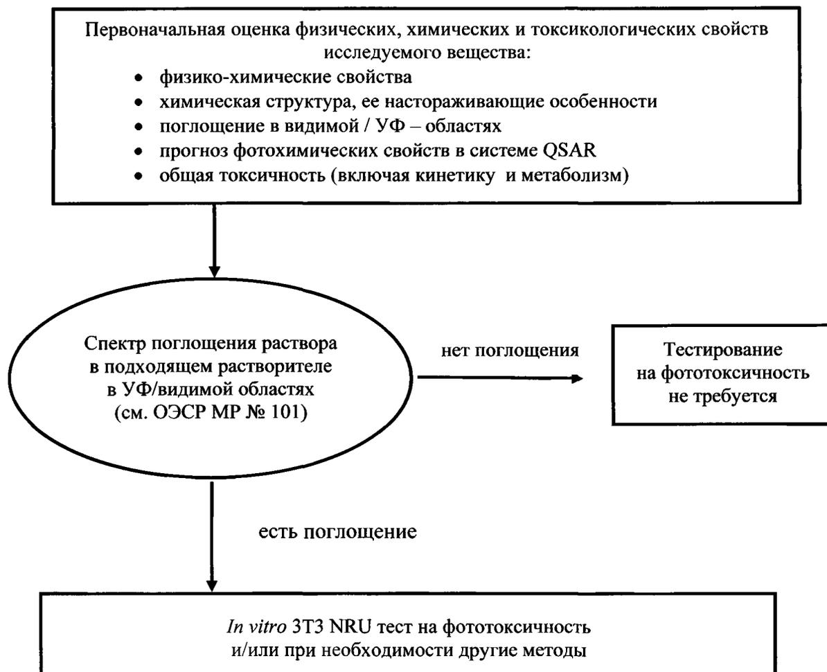
Рис. 6.4.3.1. Схема, показывающая место теста ЗТЗ NRU в последовательном подходе к тестированию химических веществ на фототоксичность
