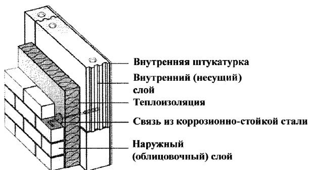
Рисунок 54 – Конструкция со слоем теплоизоляции без воздушного зазора (прослойки)
