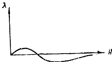
Рис. 2.18. Зависимость коэффициента магнитострикции от напряженности магнитного поля
