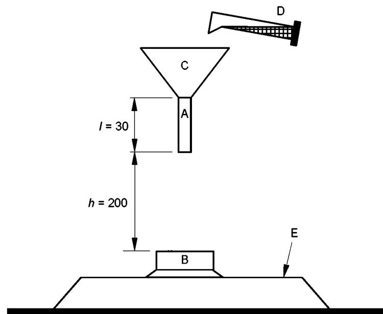
А — воронка с трубкой, внутренний диаметр которой составляет 8 мм; В — испытуемый предмет;
