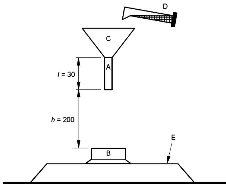
A — воронка с трубкой, внутренний диаметр которой составляет 8 мм; B — испытуемый предмет;
