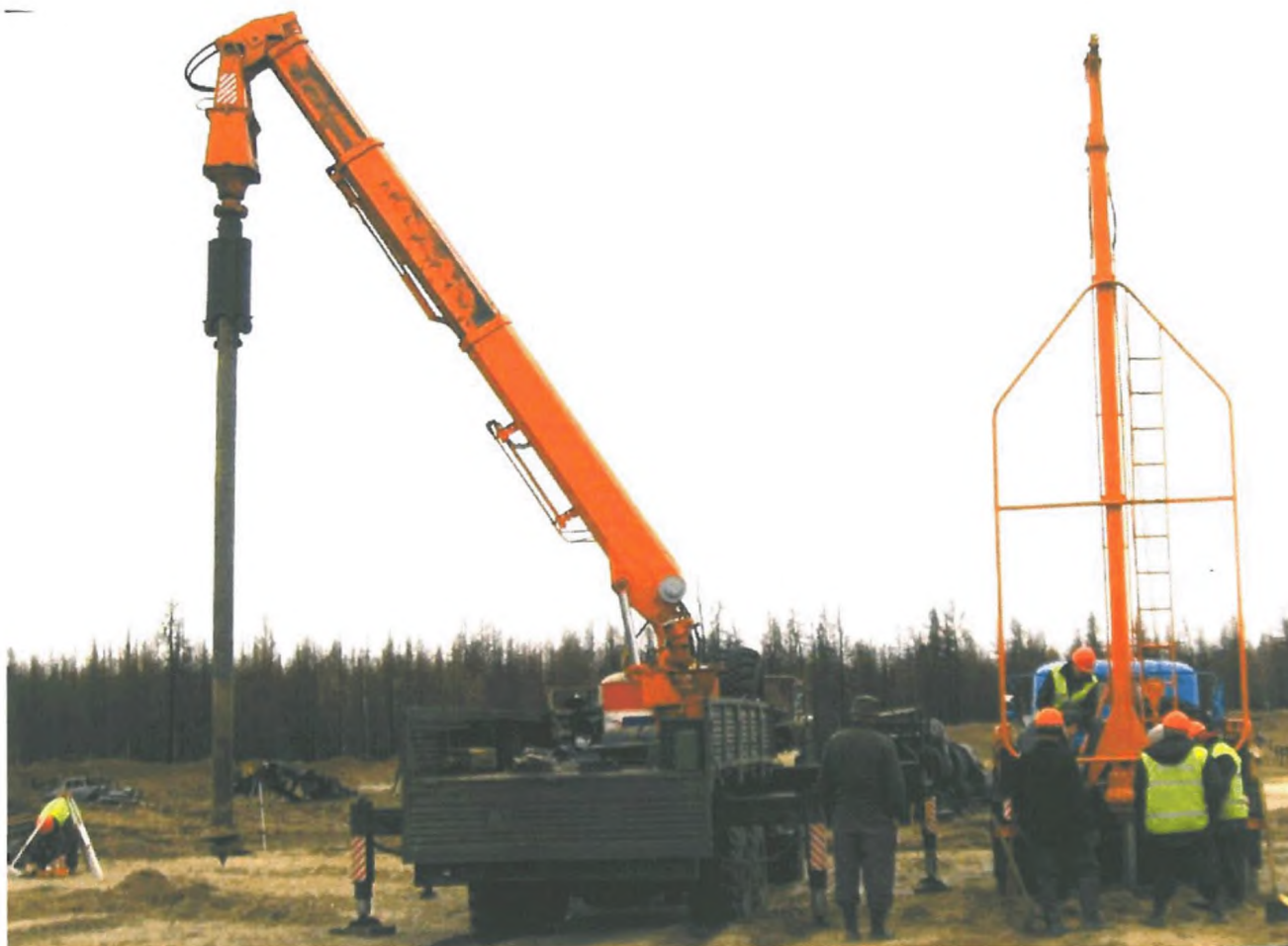
Рис. 1.1 - Универсальная бурильная машина для образования лидерных скважин и завинчивания винтовых свай УБМ-85 (слева) и бурильно-крановая машина БКМ-515 (справа)
