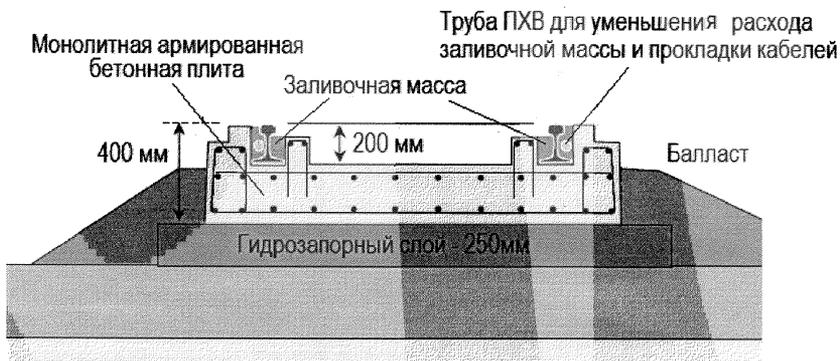
Рисунок 5 – Система безбалластного пути с непрерывной опорой для рельсов, уложенных в бетонный слой
