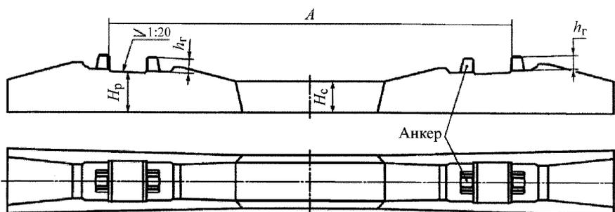
Рисунок 8 – Схема шпал типа II
