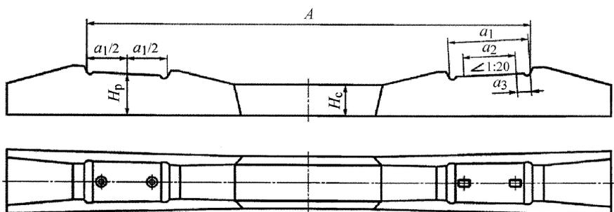
Рисунок 9 – Схема шпал типа III
