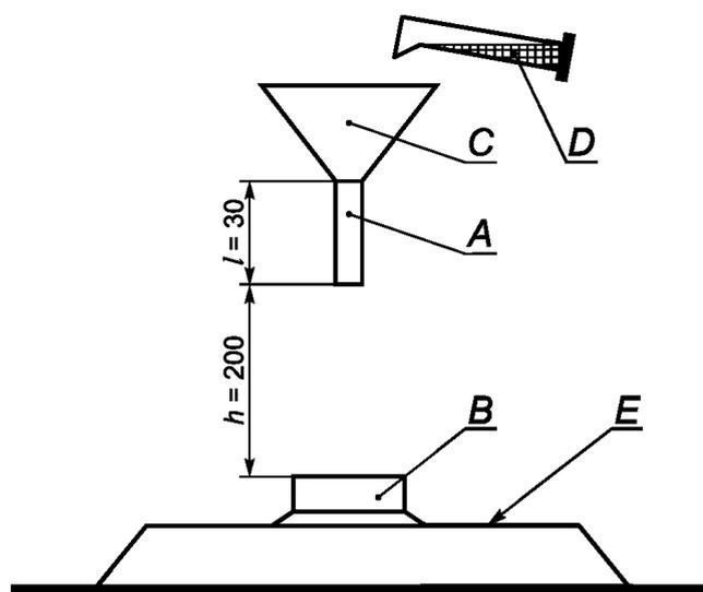
*A* — воронка с трубкой, внутренний диаметр которой составляет 8 мм; *B* — испытуемый предмет;
