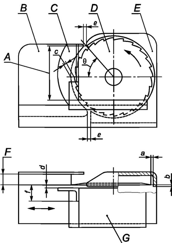
*A* — общая высота открытой секции; *B* — пластина, которая устанавливает толщину нарезки кусочков; *C* — защита большого пальца руки; *D* — вращающееся лезвие; *E* — защита лезвия;
