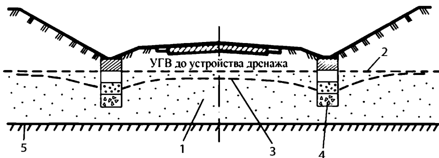
Рисунок 9 – Подкюветный односторонний совершенный дренаж
