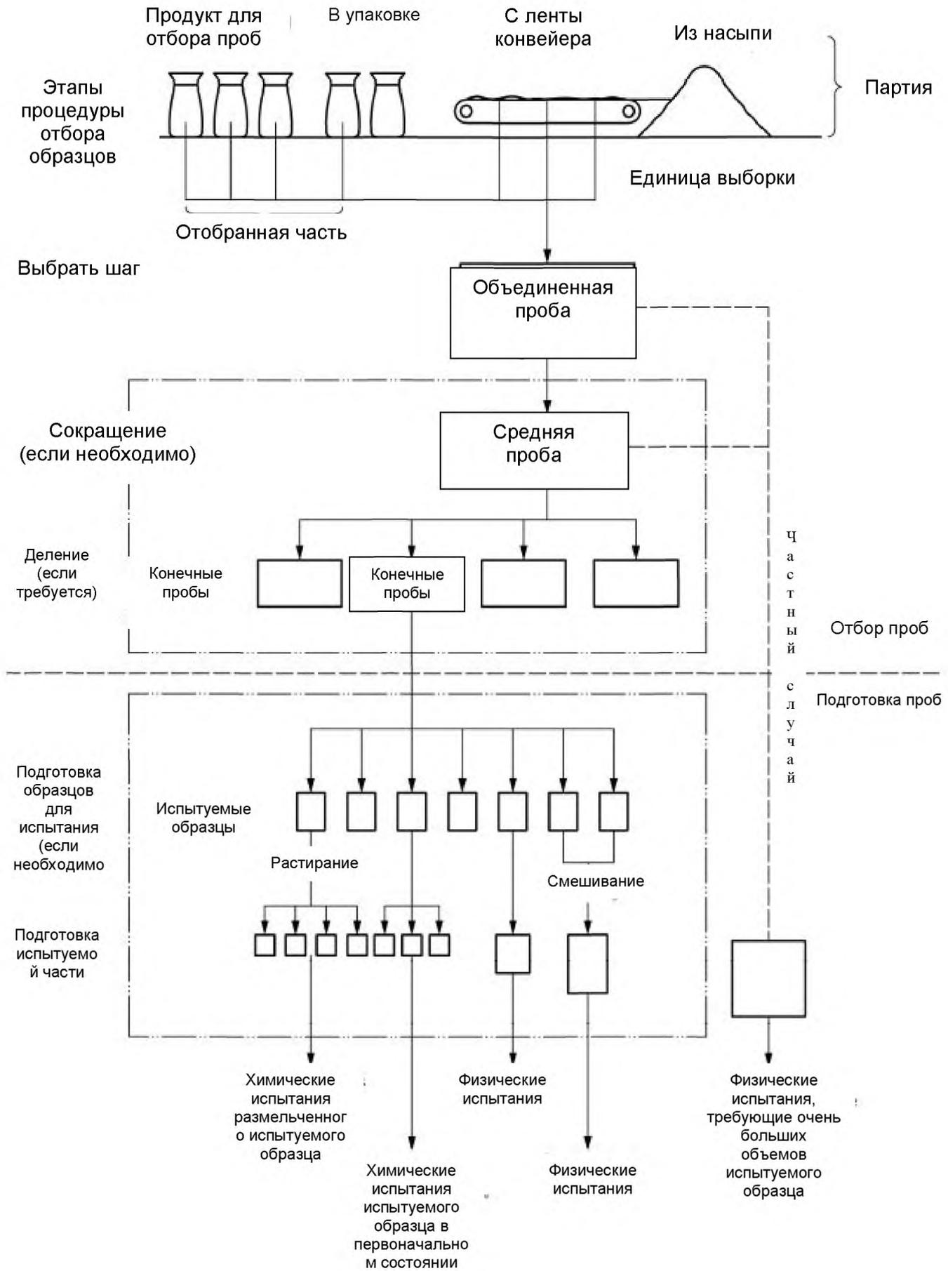
Рисунок 1 — Схема отбора проб твердых веществ
