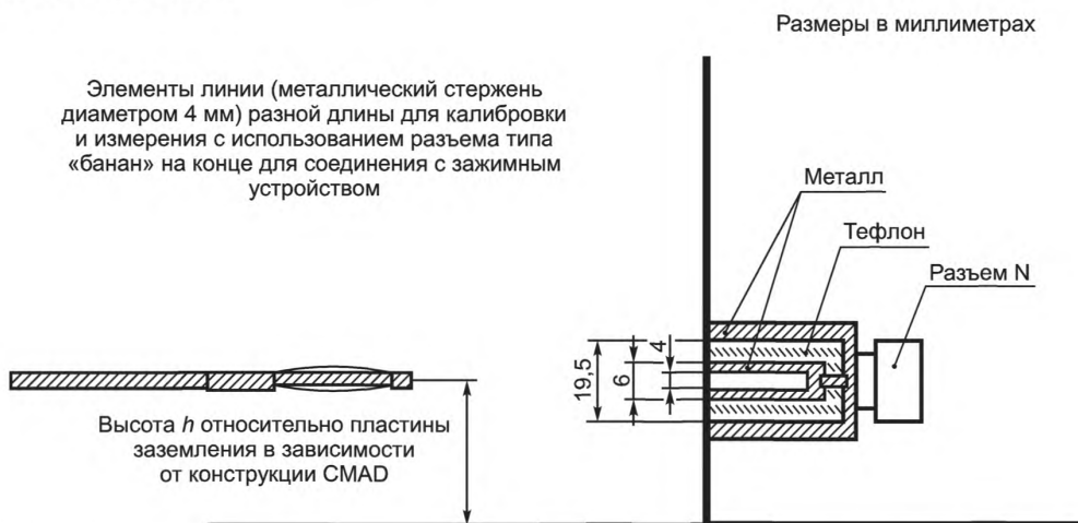
Рисунок 26 — Пример конструкции адаптера 50 Ом в вертикальном фланце зажимного устройства
