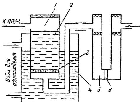
Рис. 1 – Установка для определения концентрации сероуглерода
