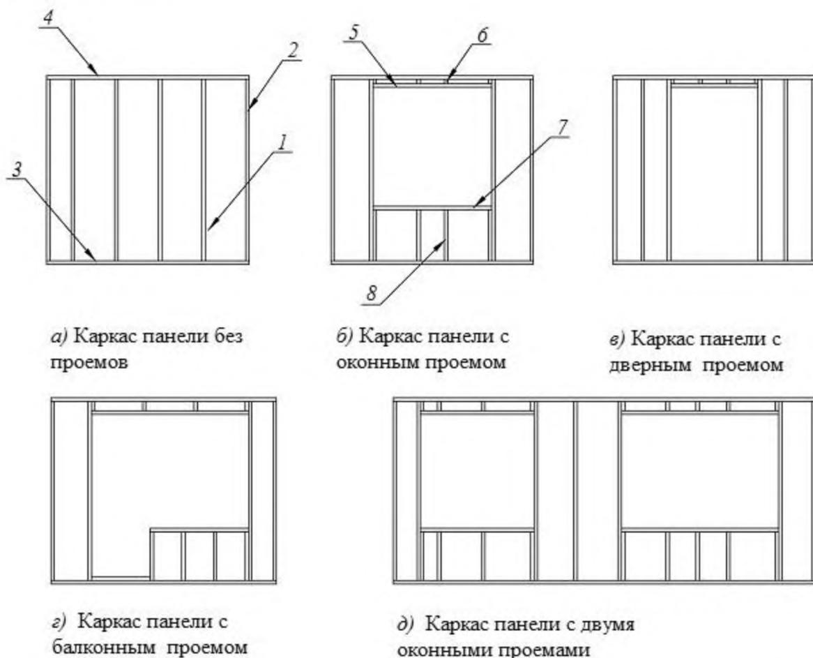
1 – боковая стойка; 2 – внутренняя стойка; 3 – нижний пояс; 4 – верхний пояс; 5 – верхняя перемычка над проемом; 6 – проставочный брусок между верхним поясом панели и верхней перемычкой над проемом; 7 – нижняя перемычка под проемом; 8 – проставочный брусок между нижним поясом и нижней перемычкой под проемом
