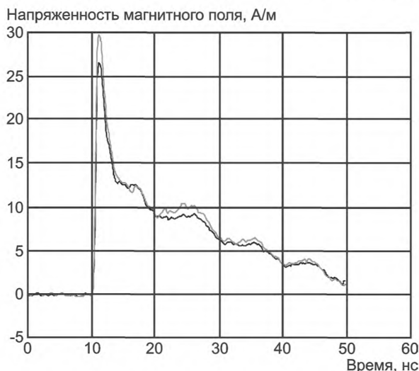
Рисунок D.2 – Зависимость от времени напряженности магнитного поля при электростатическом разряде от человека, держащего металлический предмет, заряженный до напряжения 5 кВ. Измерения на расстоянии 0,1 м при длине дуги 0,5 мм и времени нарастания силы тока 500 пс
