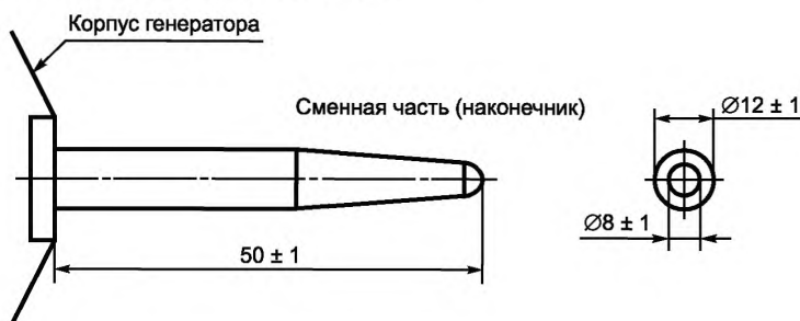
а) Разрядный наконечник для испытания методом воздушного разряда
