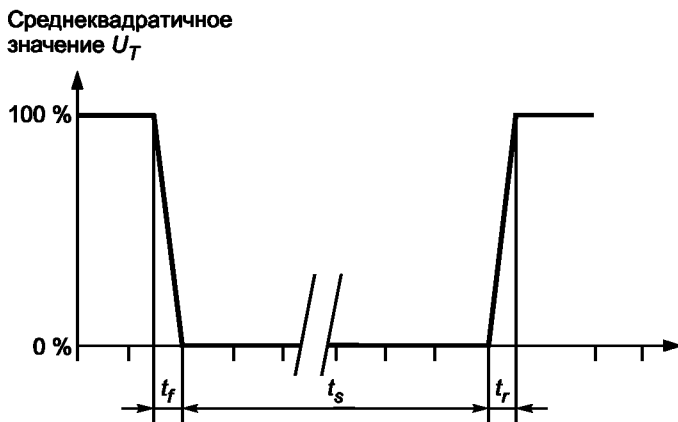
t_f — время нарастания напряжения; t_r — время понижения напряжения; t_s — время выдержки на пониженном напряжении
