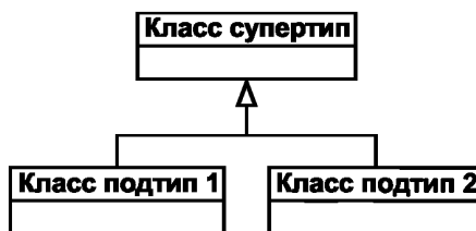
Рисунок В.7 — Нотация для супертипа/подтипов
