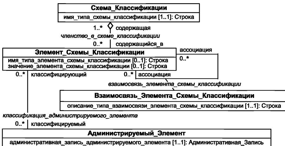
Рисунок 7 — Область классификации метамодели (Cor.1:2004)
