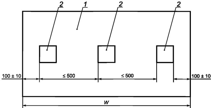
1 — полоса материала; 2 — образец;  $W$  — ширина полотна
