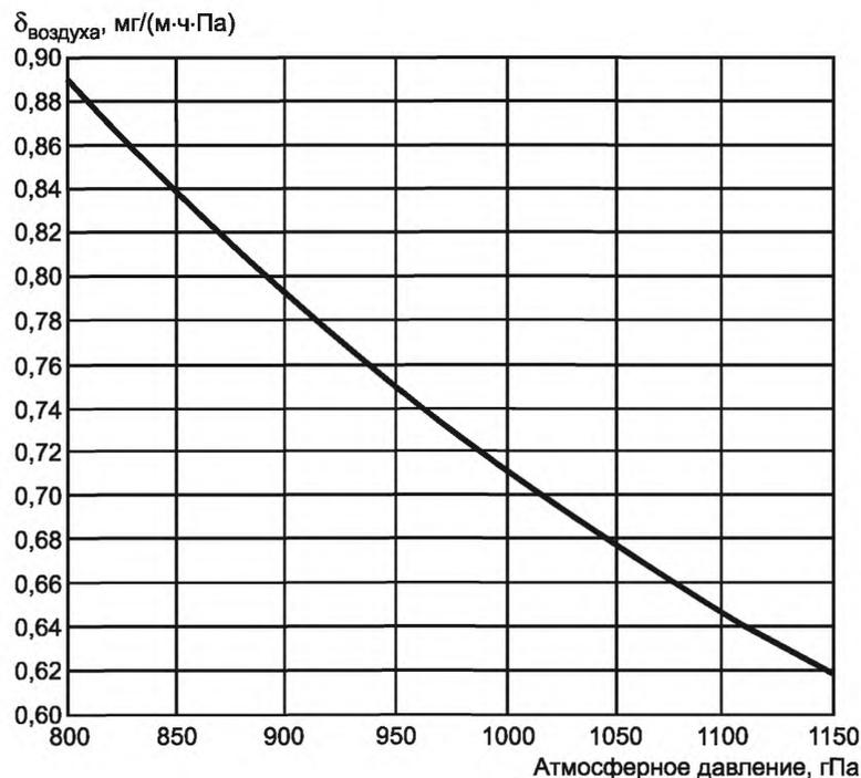
Рисунок 1 — Паропроницаемость воздуха при 23 °C
