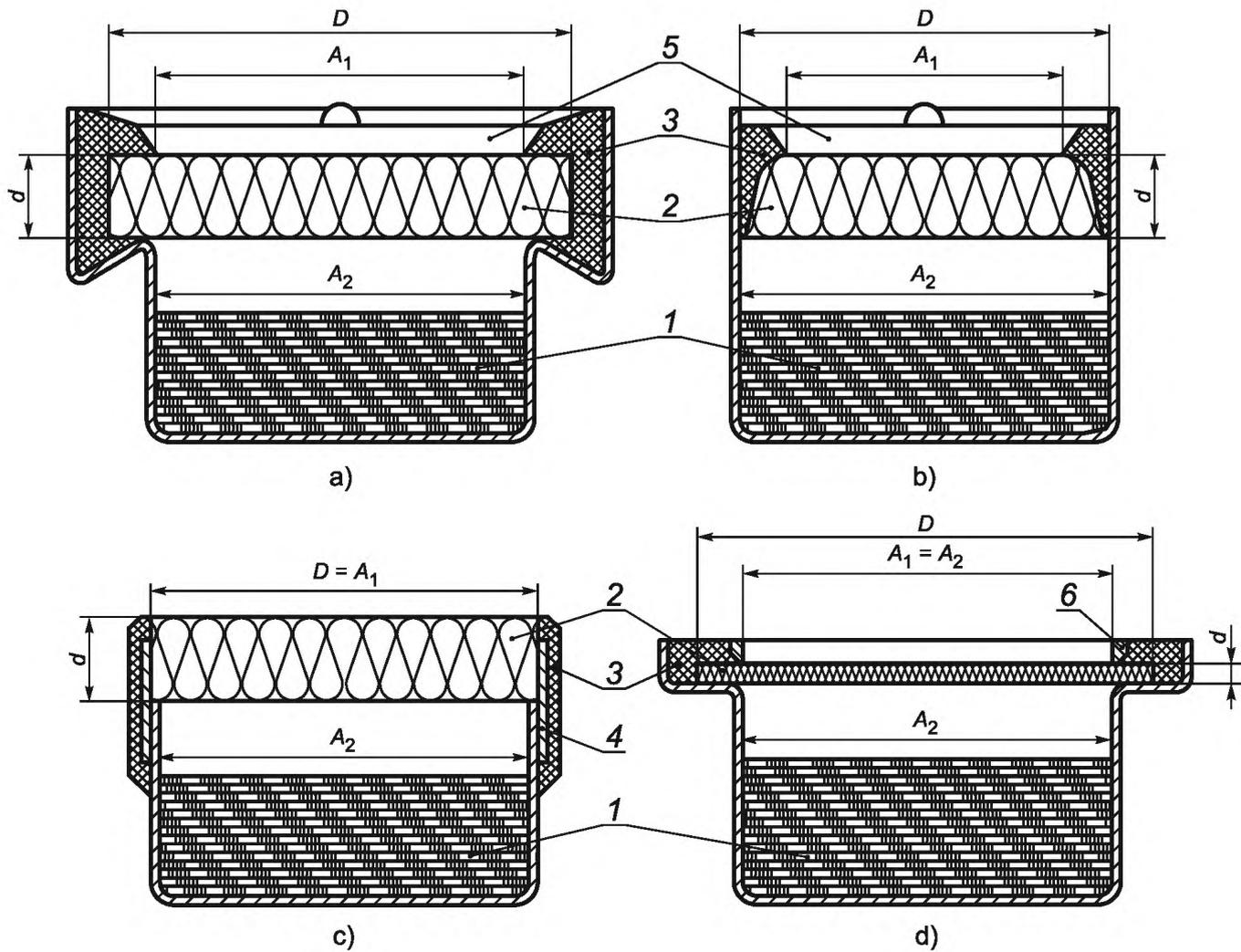
$D$  — площадь образца;  $d$  — толщина образца;  $A_1$  — верхний открытый участок образца;  $A_2$  — нижний открытый участок образца;  $A$  — среднее значение площадей открытых участков образца  $A = (A_1 + A_2)/2$ ; 1 — влагопоглотитель/насыщенный водный раствор соли; 2 — образец для испытания; 3 — герметизирующий состав; 4 — герметизирующая лента; 5 — обойма; 6 — ограничительное кольцо
