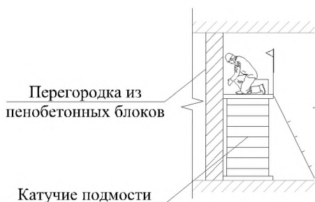
Рисунок 2. Схема производства работ с подмостей
