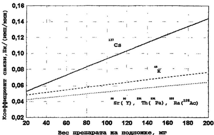
Рис. 1. Зависимость коэффициентов связи между скоростью счета импульсов от бета-излучения толстослойных препаратов радионуклидов и их активностью от массы счетного образца на подложке площадью  $2,5 \text{ см}^2$
