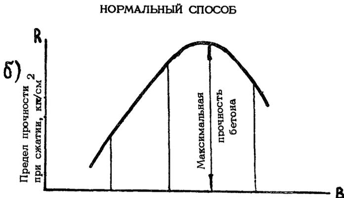
Рис. 7. Пример построения графиков для определения оптимального расхода воды: а – ускоренным способом; б – нормальным способом
