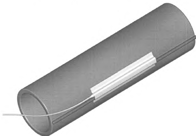
Рисунок 8 — Датчик ограничителя температуры на поверхности электронагревателя
