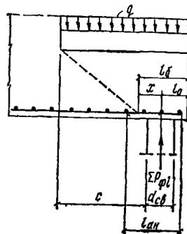
Рис. 8. Расчетная схема при проверке рабочей арматуры в плите ростверка на прочность при изгибе по наклонным сечениям
