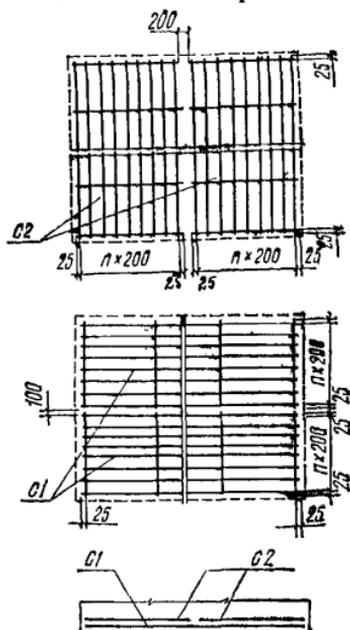
предусмотрены поперечные стержни диаметром  $\frac{d}{2}$ , где  $d$  — диаметр продольной арматуры (рис. 15).
