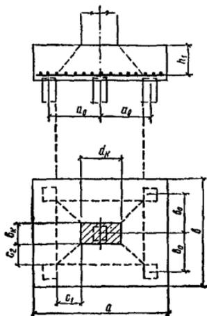
Рис. 11. Схема образования пирамиды продавливания при монолитной железобетонной колонне
