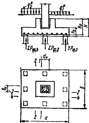
Рис. 7. Расчетная схема для определения арматуры подошвы ростверка
