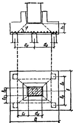
Рис. 1. Схема образования пирамиды продавливания под сборной железобетонной колонной прямоугольного сечения
