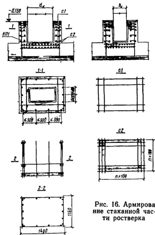
Рис. 16. Армирование стаканной части ростверка
