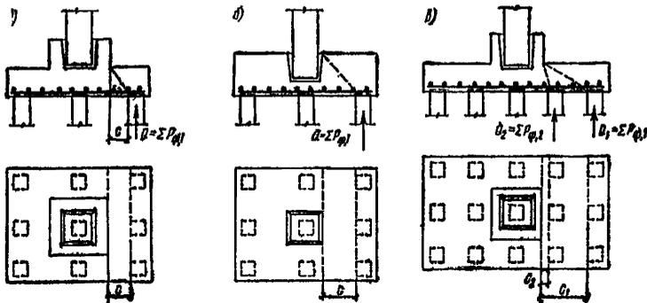
Рис. 6. Схемы, принимаемые при расчете прочности наклонных сечений ростверка по поперечной силе
