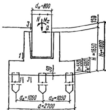
в плане  $150 \times 120$  см. Колонна заделывается в ростверк на глубину  $h_k = 90$  см. Отметка верха ростверка 0,15 м (от уровня чистого пола).
