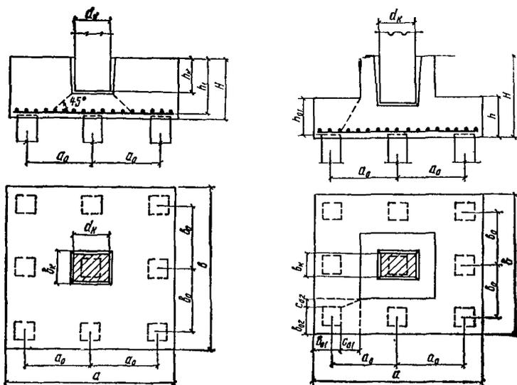
Рис. 4. Схема свайного фундамента с плитным ростверком
