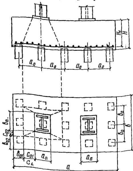
Рис. 14. Схема образования пирамиды продавливания при стальных сквозных (решчатых) колоннах, имеющих отдельные стальные базы под каждой ветвью
