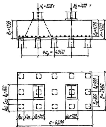
Рис. 19. Свайный фундамент под стальную колонну
