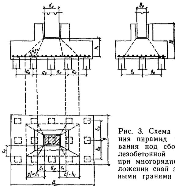
Рис. 3. Схема образования пирамид продавливания под сборной железобетонной колонной при многорядном расположении свай за наружными гранями колонны
