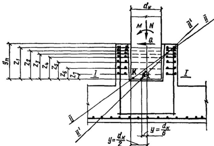
Рис. 9. Расчетная схема стаканной части ростверка
