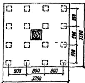
Рис. 20. Плитный ростверк свайного фундамента под сборную железобетонную колонну
