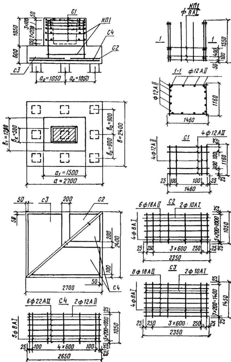
Рис. 18. Армирование ростверка
