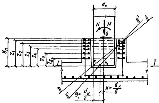
Рис. 10. Расчетная схема стаканной части ростверка при заглублении стакана в плитную часть ростверка
