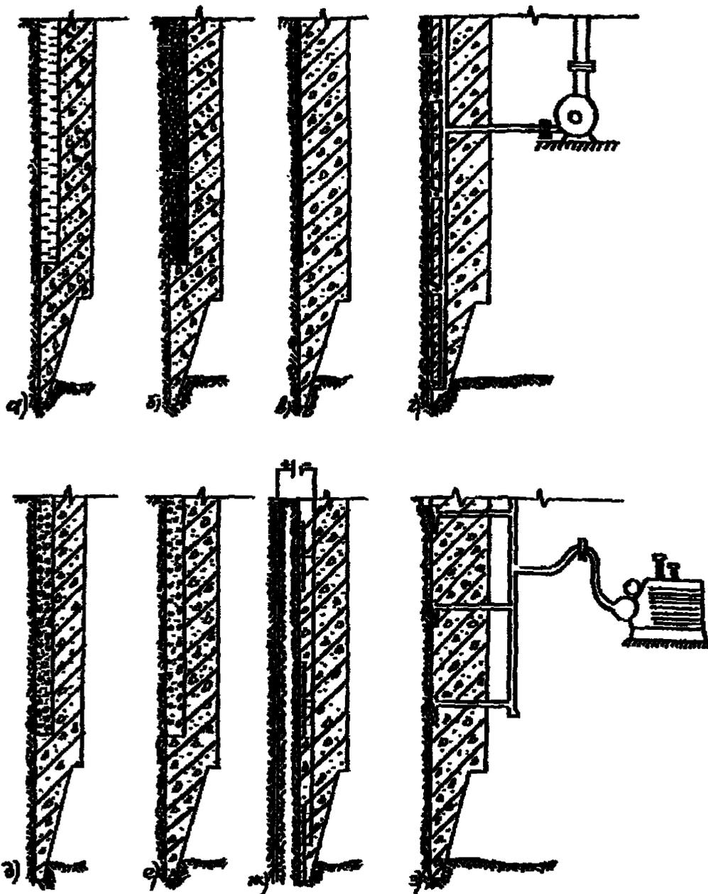
Рис. 7. Способы снижения сил трения боковой поверхности опускных сооружений о грунт: а - тиксотропная рубашка; б - стабилизированная тиксотропная рубашка; в - антифрикционная обмазка; г - гидроподъем; д - податливая оболочка; е - гидрофобизация поверхности податливой оболочки; ж - электросветовое увлажнение; з - пневматическая рубашка
