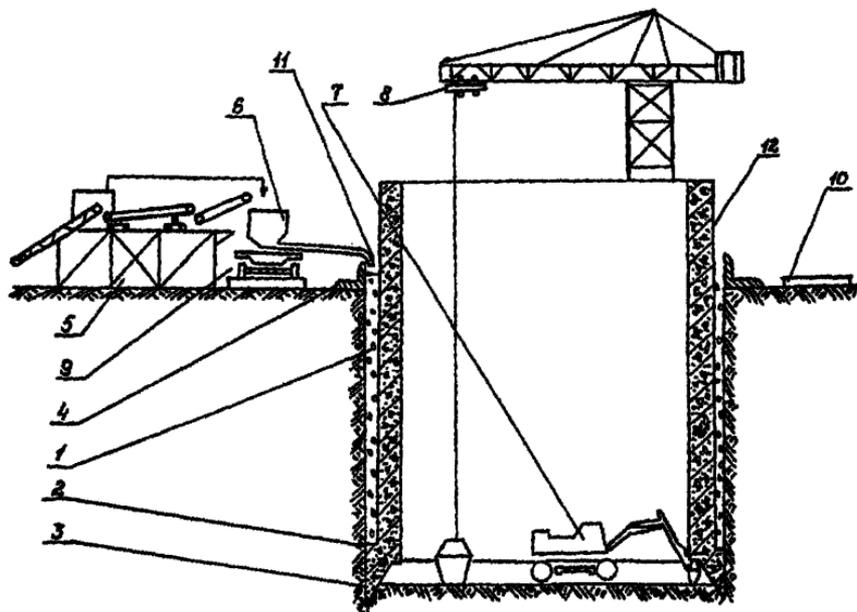
Рис. 8. Схема образования податливой оболочки: 1 - податливая оболочка; 2 - уступ ножевой части; 3 - ножевая часть; 4 - формакта; 5 - материальный склад; 6 - передвижной смесительный узел; 7 - измерительное оборудование; 8 - грунтоподъемный механизм; 9 - ковровая тележка; 10 - кольцевая дорога; 11 - трубопровод; 12 - опускной колодезь
