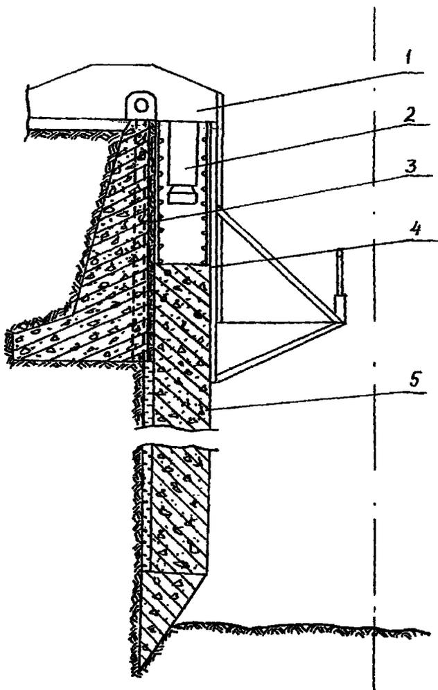
Рис. 6. Погружение колодез заделыванием с монолитными железобетонными стенами: 1 - консольные упоры; 2 - домкраты; 3 - наружная опалубка; 4 - внутренняя опалубка; 5 - опускаемой колодез
