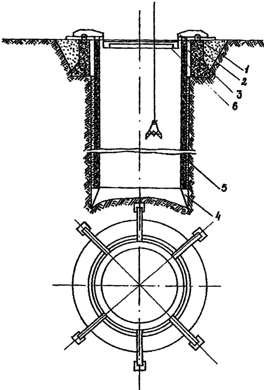
Рис.5 Схема погружения колодца задавливанием
