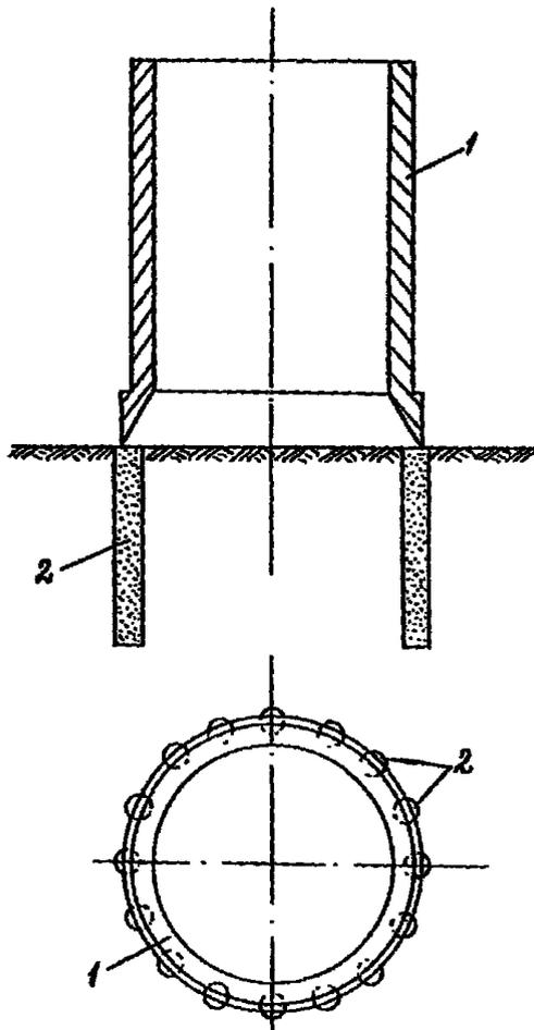
Рис.4 Погружение опускаемого колодца на песчаных сваях
