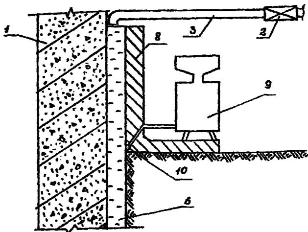
Рис. 9. Снижение трения при погружении колодез путем устройства податливой оболочки и гидрофобизации ее поверхности:
