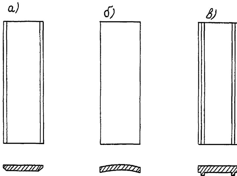
Рис. 2. Стеновые панели опускных колодцев: а) плоские, б) вогнутые; в) ребристые
