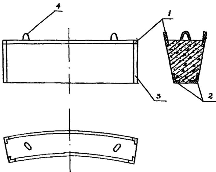
Рис.1. Сегментные железобетонные блоки
