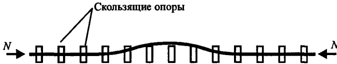
Рисунок 9.3. – Форма потери устойчивости бесконечно длинного трубопровода на скользящих опорах
