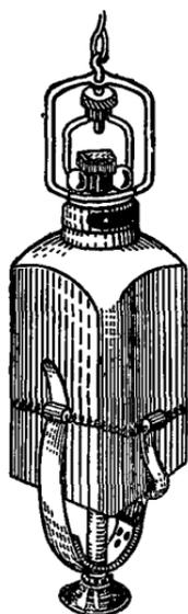
Рис. 2. Батометр
